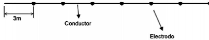
Figura N°29. Diagrama de conexión de la malla de puesta a tierra.
