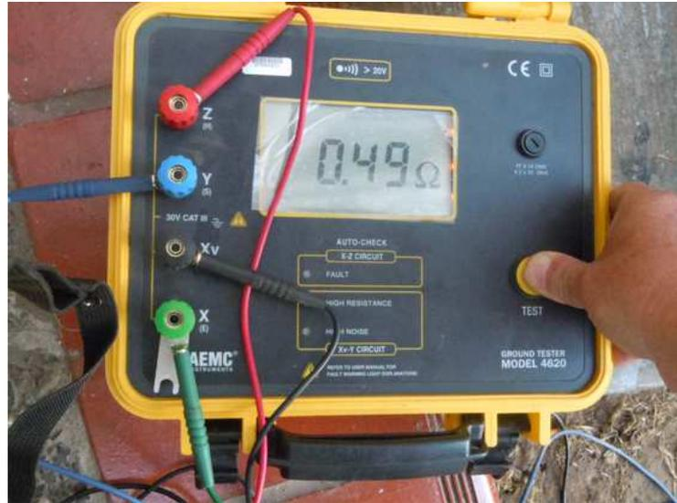
*Figura N°25. Medición práctica de resistividad del suelo con megger.*
