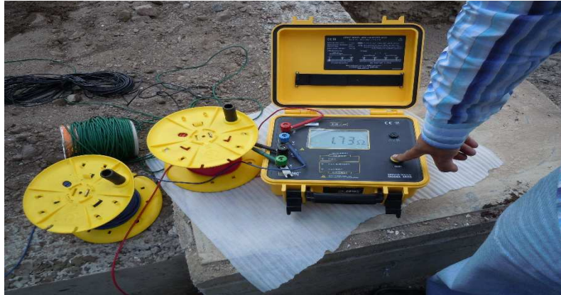
Figura 5.10.- Equipo y valor de la resistividad de nuestra planta.
