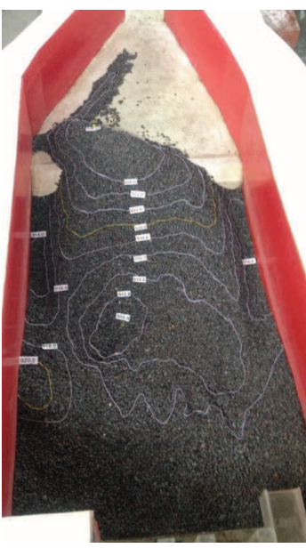
Fotografía 7.3: Foso socavado, Q=57,28 l/s, Escenario N°3
