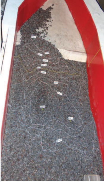
Fotografía 7.2: Foso socavado, Q=57,02 l/s, Escenario N°2
