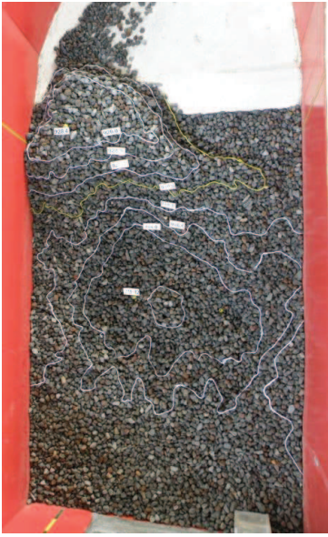
Fotografía 7.1: Foso socavado, Q=56,51 l/s, Escenario N°1
