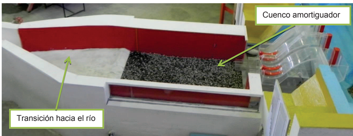
Fotografía 4.7: Zona de salida del modelo de la presa Toachi
