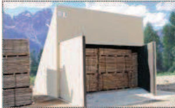
Figura 1. 5Secador por energía solar<sup>10</sup>
