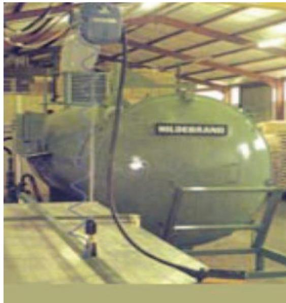
**Figura 1. 6Secador al vacío<sup>12</sup>**
