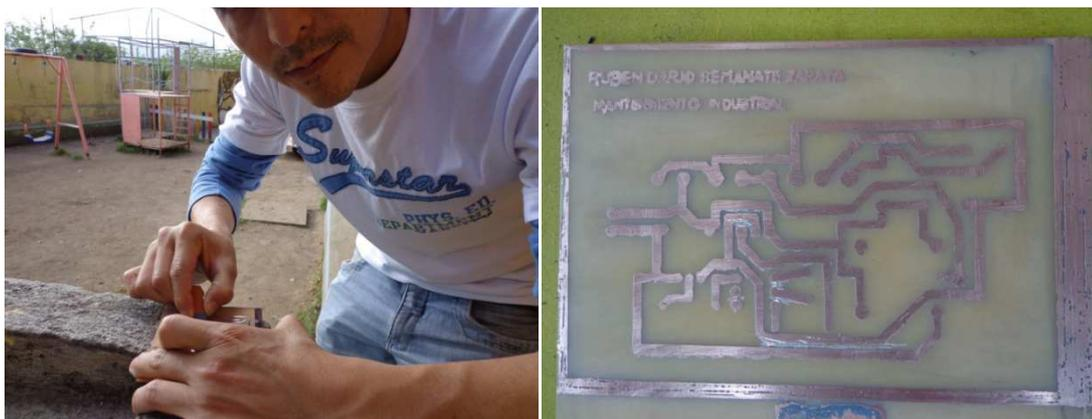
*Figura 40: Eliminando tinta e impurezas de la baquelita*
