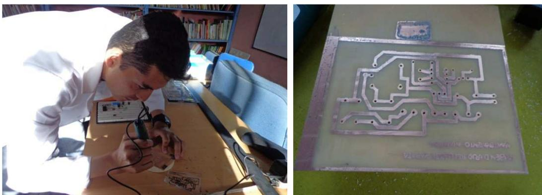
*Figura 41: Perforando la baquelita*
