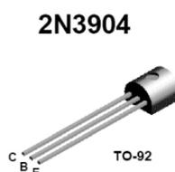
Figura 27: Distribución de pines del transistor
