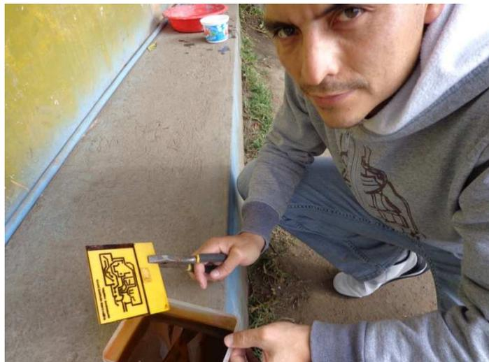
*Figura 38: Retiro de la baquelita de la mezcla agua-ácido sulfúrico*
