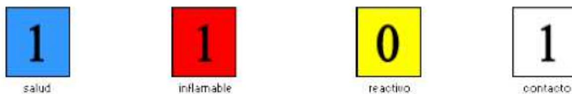
Figura 1.19. Código de Winkler para la seguridad en el manejo de la ditionamida (Winkler, 2007, p.2)
