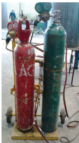
Figura 1-2 Corte con gas oxi-combustible.
