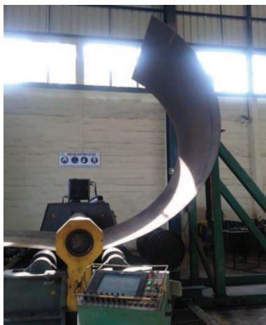
Figura 1-11 Lámina metálica de trabajo pre curvado.
