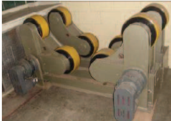
Figura 2-13 Equipo de posicionamiento instalado en planta.
