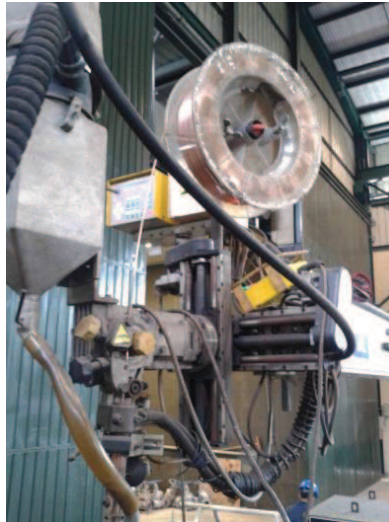
Figura 2-12 Equipo de soldadura SAW.
