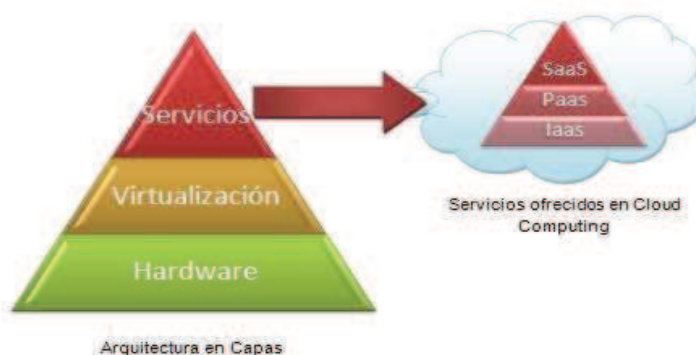
Figura 1. 4 Arquitectura en capas de Cloud Computing
