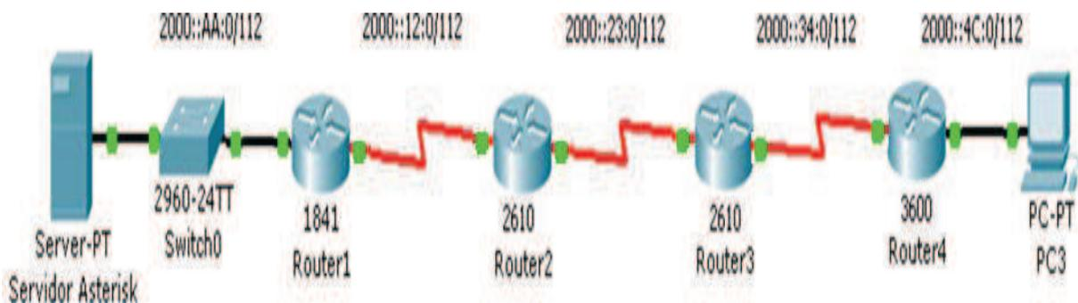
Figura 3.2 Diagrama de Topología del Segmento de Red IPv6 puro
