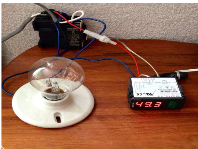
Figura 5.15.- Sistema de control.
