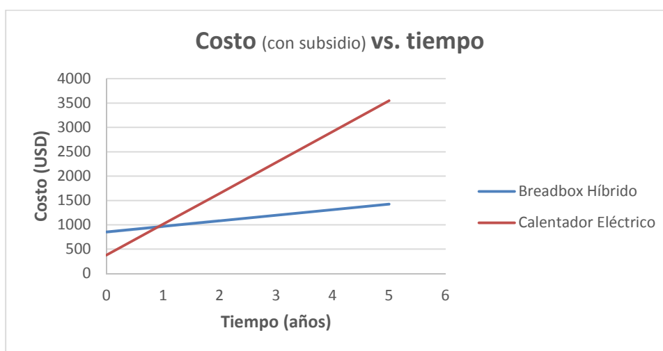
Figura 5.38.- Bread-Box Híbrido vs. Calentador Eléctrico (con subsidio)
