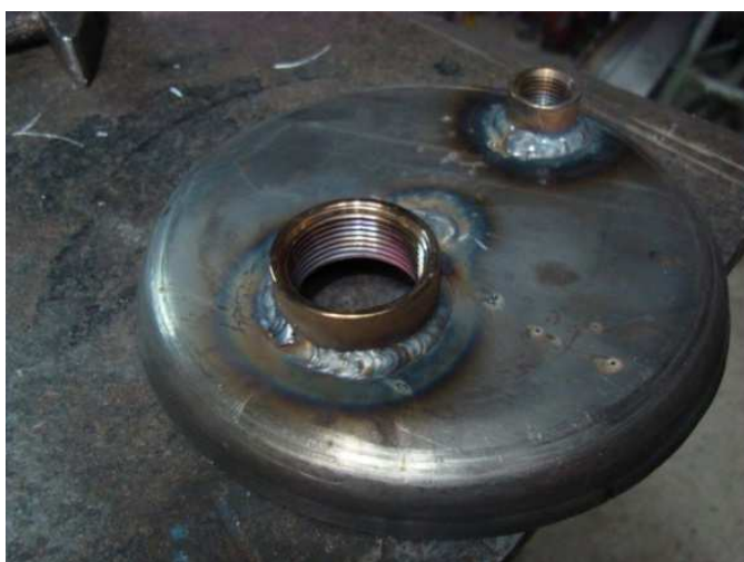
Figura 5.8.- Uniones soldadas a la tapa del tanque.
