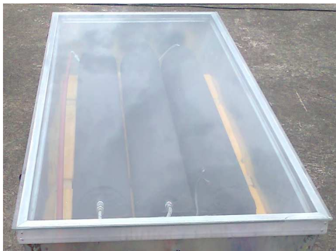
Figura 5.12.- Cubierta de vidrio y aluminio anodizado.
