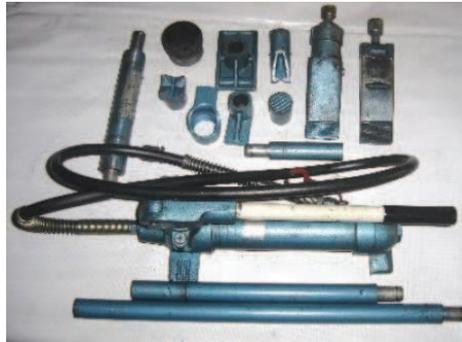
**Imagen B.25. Equipo de estiramiento mecánico.**
