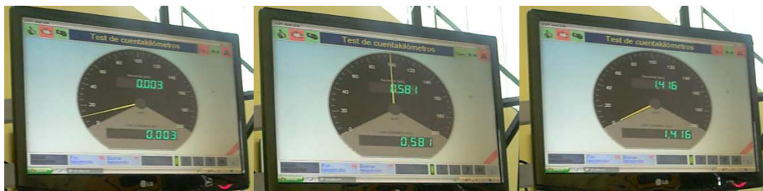
Figura 4-7 Interfaz gráfica del dinamómetro: 10km/h – 100 km/h – 0km/h
