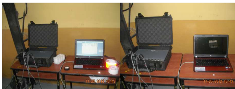
Figura 4-6 ADQ interconectado a la PC para minotoreo de vibraciones
