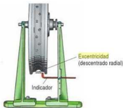
Figura 2-12 Medición de la excentricidad
