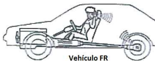
Figura 3-23 Ruido generado en el engranaje diferencial: vehículo con propulsión trasera
