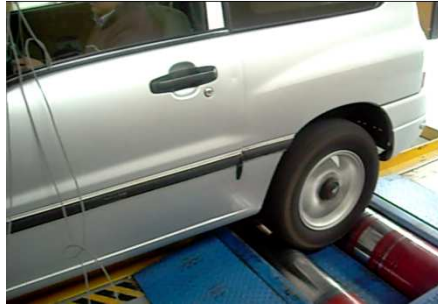
Figura 4-4 Vehículo ubicado sobre el dinamómetro
