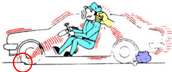
Figura 3-11 Golpeteo por impacto longitudinal
