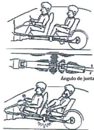
Figura 3-26 Ruido generado por ángulo de junta
