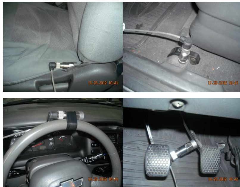
Figura 4-1 Dsiposición de los acelerómetros dentro de la cabina
