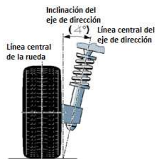
Figura 2-6 Inclinación del eje de la dirección o ángulo Kingpin
