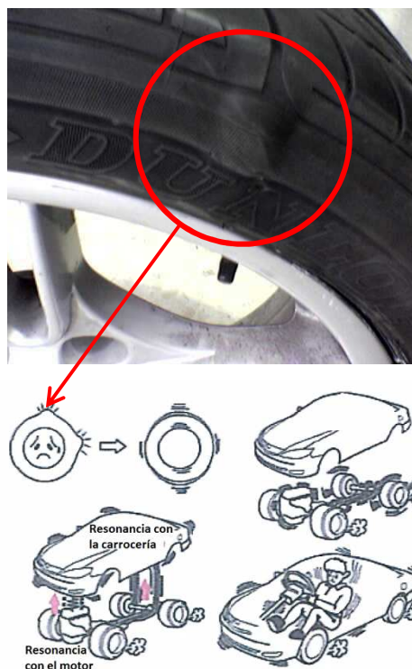
Figura 3-2 Mecanismo de generación de la sacudida de la carrocería
