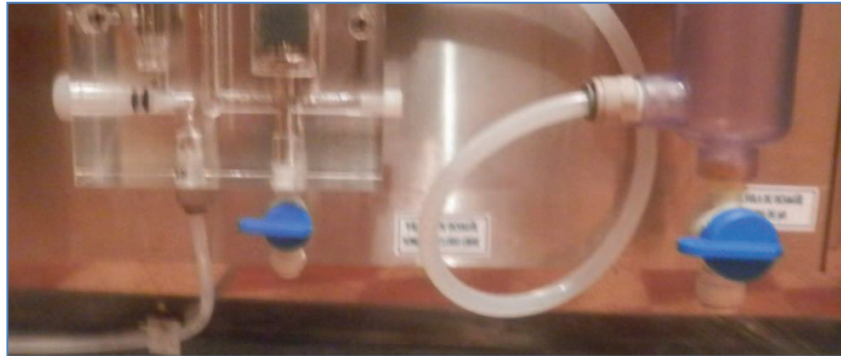
Figura 30. Válvulas de desagüe de las Sondas del CLF10sc
