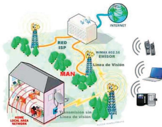
**Figura 1.4:** Diagrama de una red WiMAX. [11]
