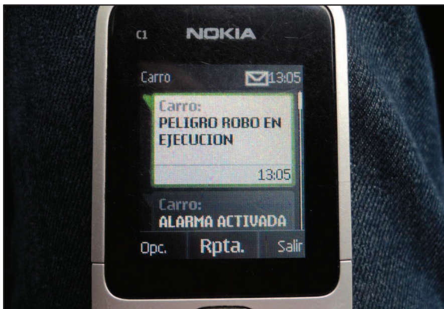
Figura 5.30 Mensaje de texto de respuesta del módulo GSM de “Peligro robo en ejecución”
