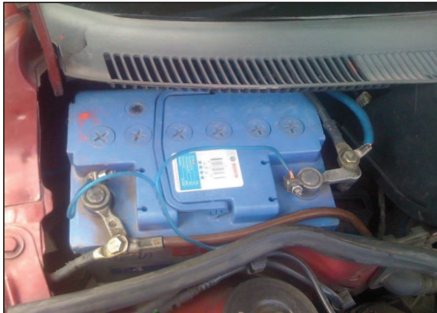
Figura 5.6 Alimentación desde la batería del vehículo
