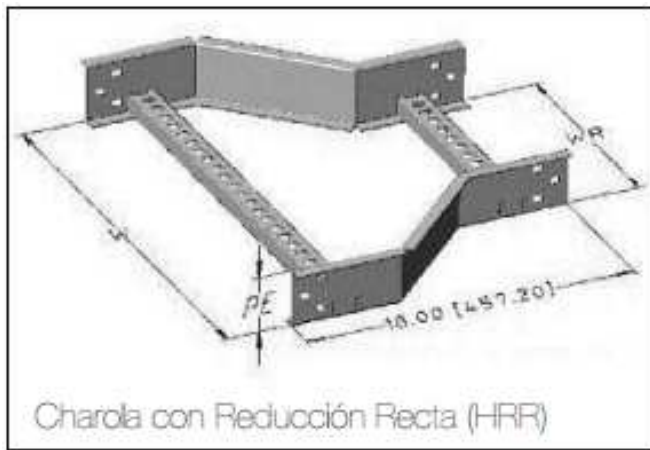
Figura 2.9 Reducciones rectas, (derecha e izquierda).
