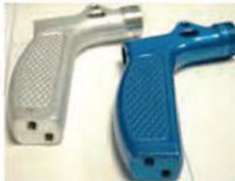
Figura 1.5. Piezas de aluminio anodizado con diferente coloración (Gómez et al., 2011, p. 90)
