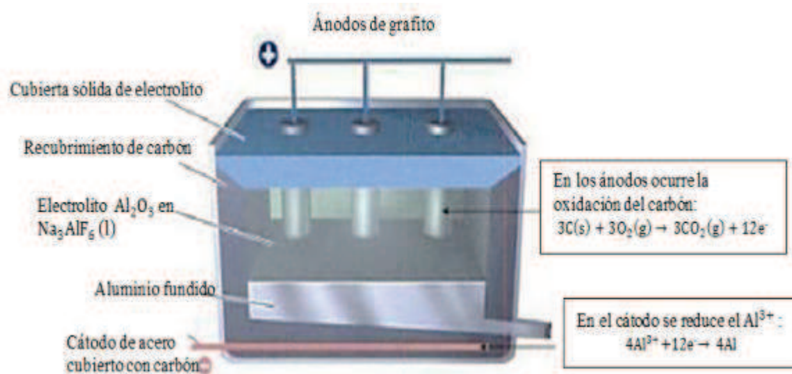
Figura 1.2. Diagrama de la celda reductora (Whitten, Davis, Peck y Stanley, 2008, p. 849)
