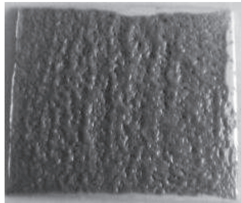
Figura 3.4. Placa recubierta con esmalte E-III a 600 °C, con limpieza convencional y precalentamiento
