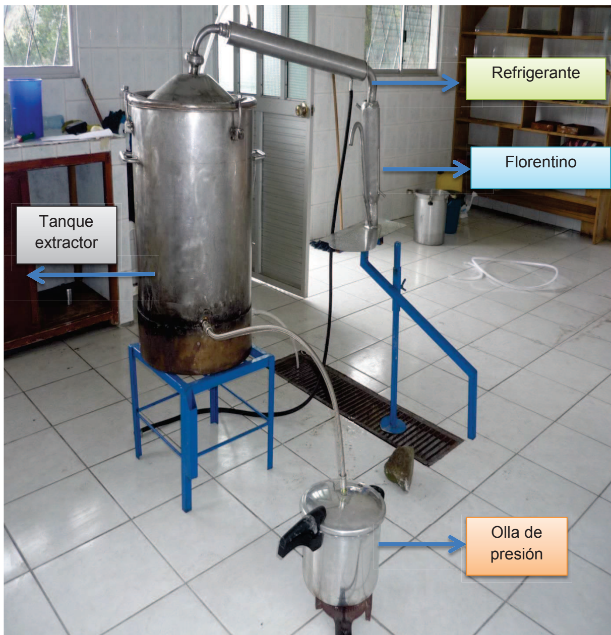
Figura AI.3. Equipo para la extracción del aceite esencial de palo santo a escala semi-piloto
