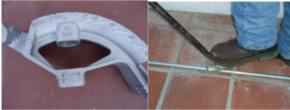
Figura 3.16 Dobladora de tubo
