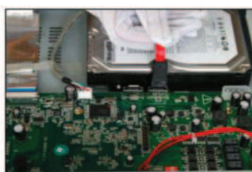
4) Conectar el cable de datos al puerto de la placa del DVR
