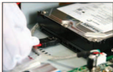
5) Conectar el cable de datos al puerto del Disco duro
