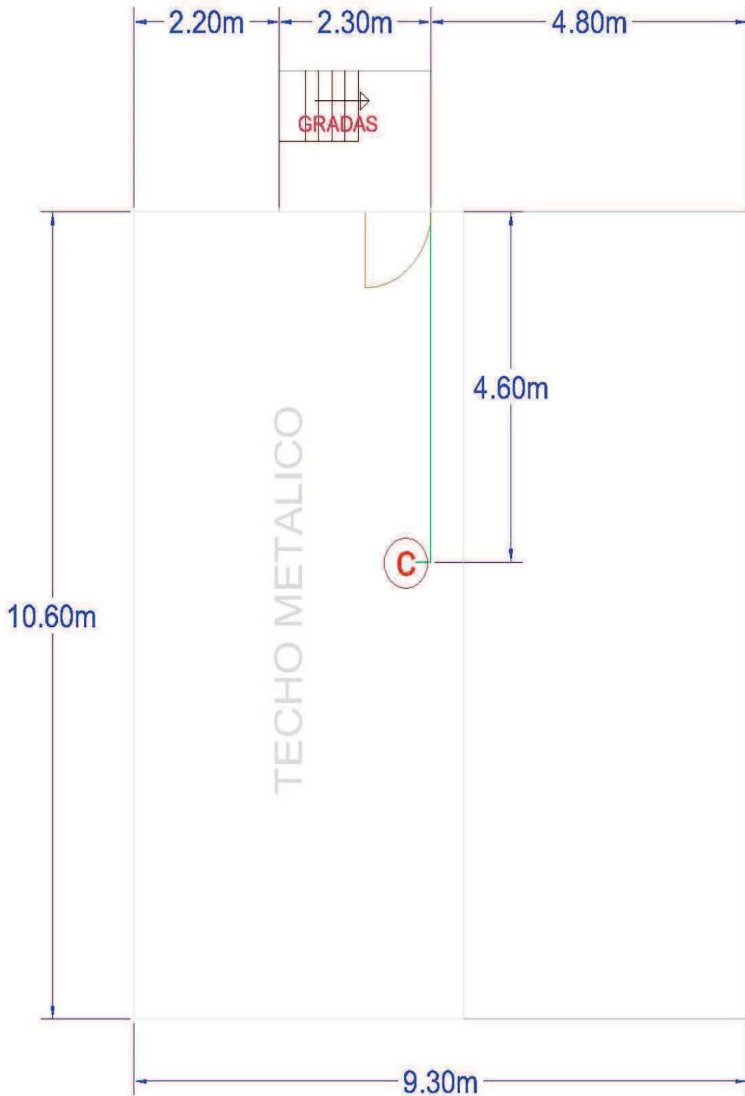
Figura 3.7 Mapa de cableado de la terraza
