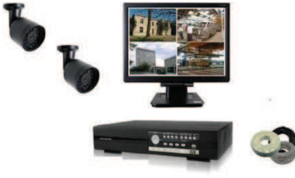
Figura 1.1 Elementos básicos de un CCTV [2]
