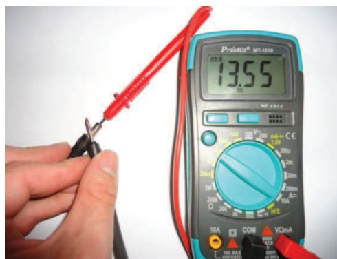
Figura 4.3 Medición de fuentes de alimentación para cámaras de vigilancia
