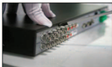
1) Retirar los tornillos de la parte posterior del DVR
