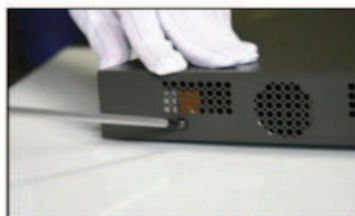
2) Retirar los tornillos de los costados del DVR
