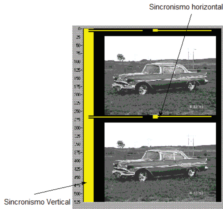
Figura 1.9 Sincronismos verticales y horizontales en un video [9]
