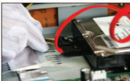
7) Conectar el cable de energía al Disco duro
