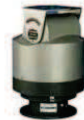
Figura 1.16 Unidad de PAN & TILT [24]
