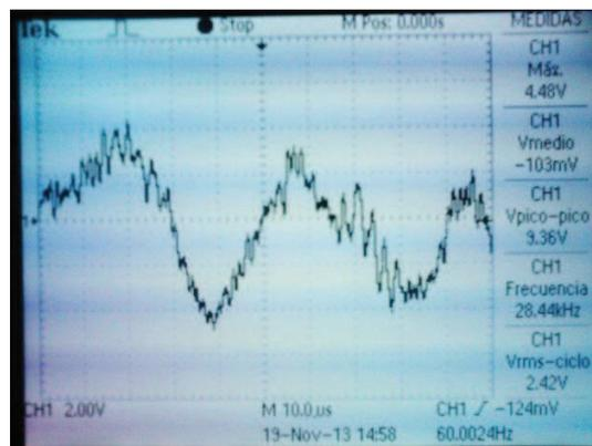
*Figura93. Señal de entrada, circuito secundario. Antena EO.*
