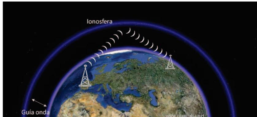
*Figura 1. Ionósfera utilizada como reflector de señales. [1]*
