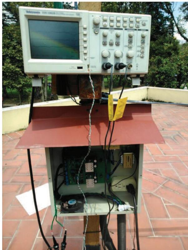
*Figura98. Conexión prueba diferencial Antena NS*
