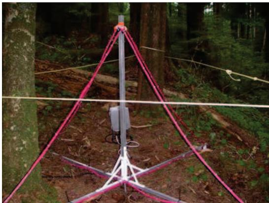
*Figura 11. Antena triangular de lazo ortogonal, Proyecto AWESOME. [3]*
