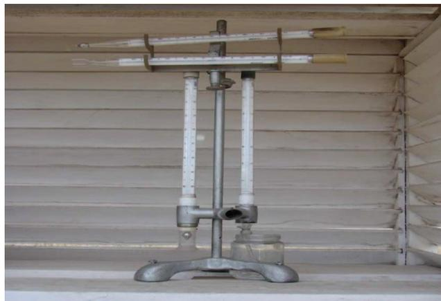
Figura 2. 12 Termómetro ambiental y termo higrómetro.
