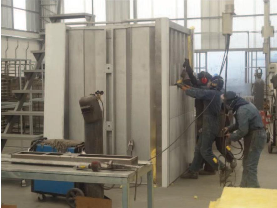
**SOLDADURA DE LOS TUBOS ENTRE LOS ESPEJOS**
