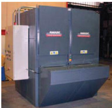
Figura 1. 7 Hornos eléctricos para secado de pintura en polvo
