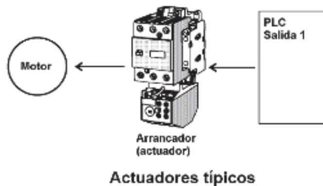
Figura 2. 28 Forma de conexión de un motor a través de un PLC.
