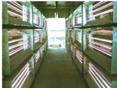
**Figura 1. 8 Hornos infrarrojos para el secado de pintura electrostática**
