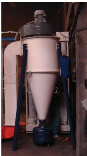
**Figura 1. 6** Ciclón para pintura electrostática
