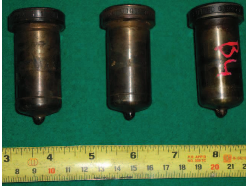
Figura 3. 3. Recepción de las toberas sin refrigerar del equipo D-0201D de la estación Cayagama (PS2).
