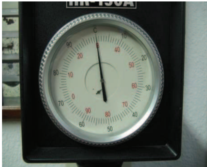
Figura 3. 7. Lectura de dureza en la escala Rockwell B, Rockwell C.
