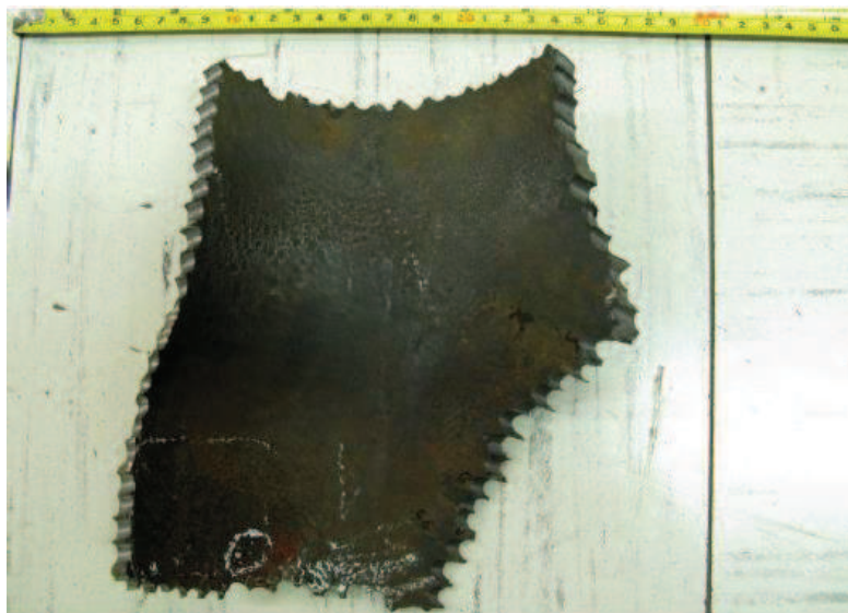
Figura C 6. Carcasa del turbocargador con presencia de perforaciones.
