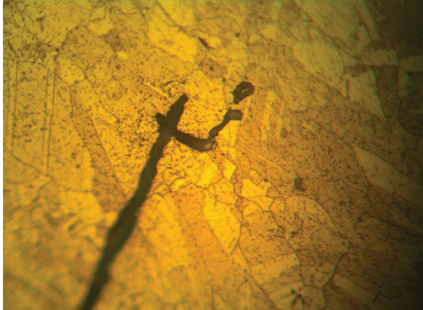
Figura G 1. Microestructura de sección transversal tomada a 500X, presenta precipitados de carburos y una grieta en la dirección trasversal.
