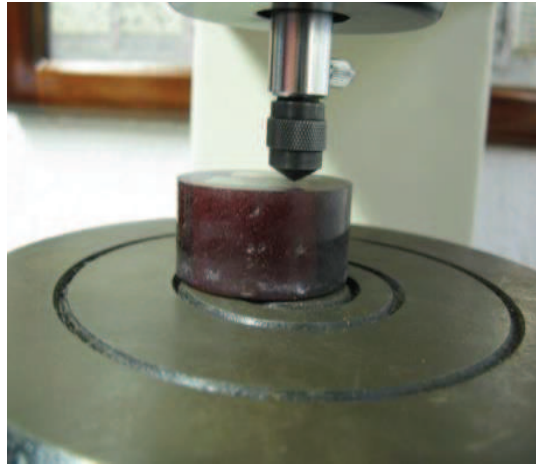
Figura 3. 6. Posicionamiento del indentador sobre la superficie a medir.
