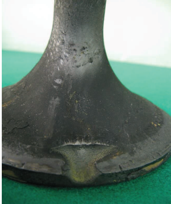
Figura C 3. Válvula con pérdida de material.
