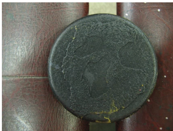
Figura C 4. Válvula sin pérdida de material.
