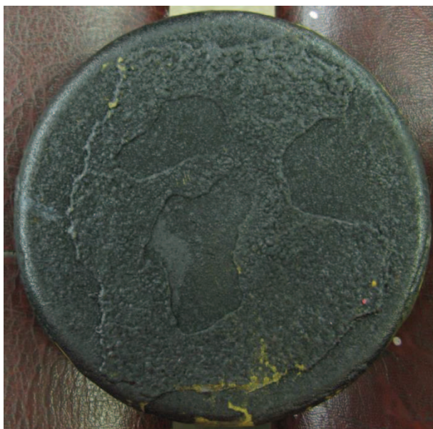
Figura 1. 1. Válvula de escape del motor D-0101D con depósitos de carbón.
