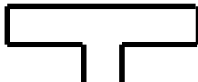
Antena dipolo doblado para medir el campo en z ( E_z )
