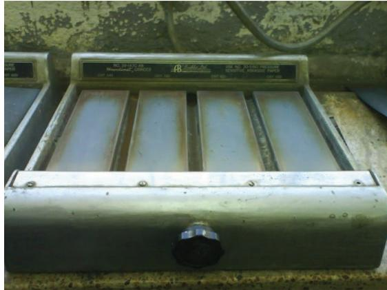
Figura 1.21 Máquina para desbaste fino
