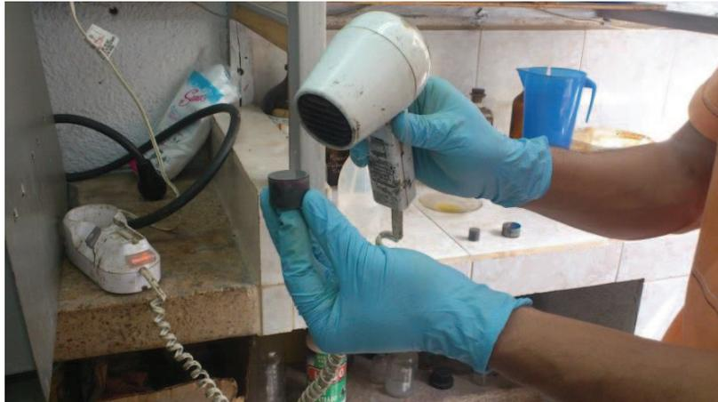
Figura 1.25 Uso de aire caliente para eliminar exceso de agua en la probeta.
