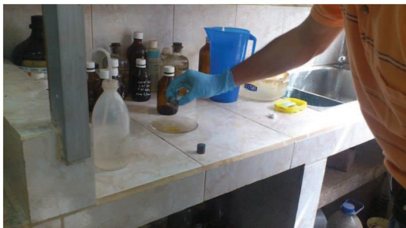
Figura 1.24 Ataque químico (inmersión de la probeta en el reactivo)
