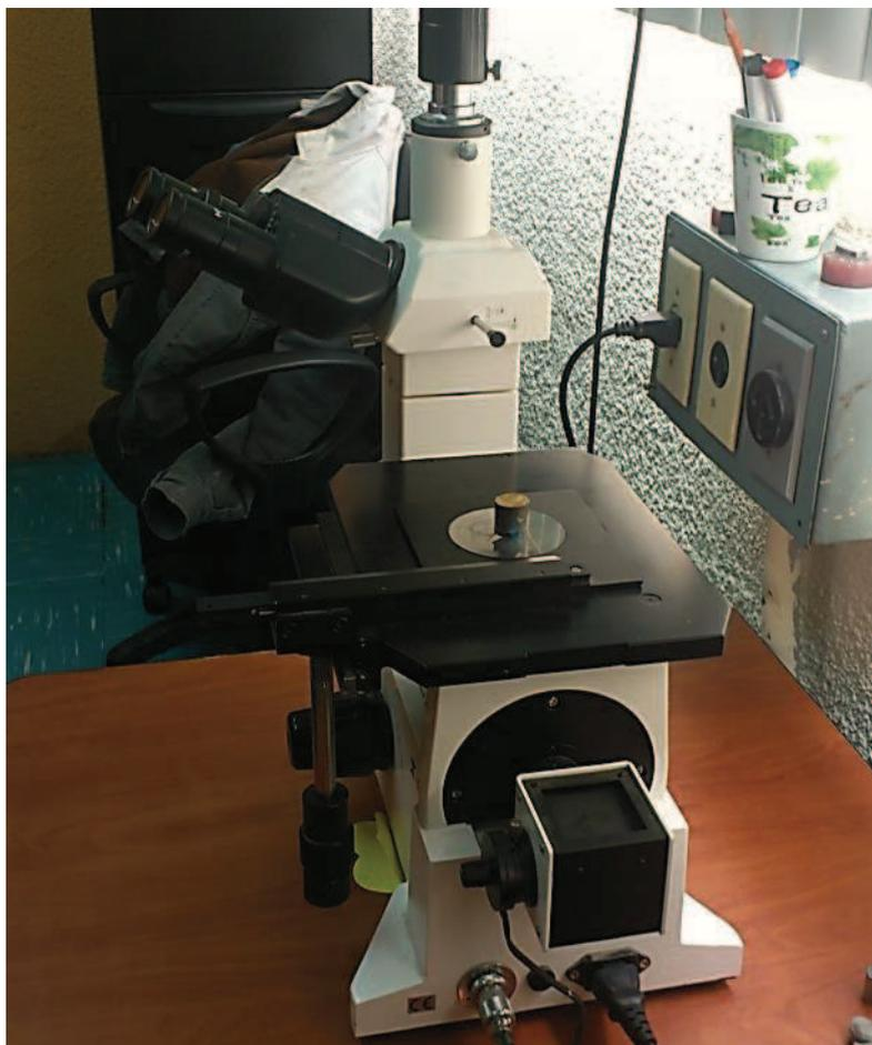
Figura 1.27 Ajuste de microscopio metalográfico del laboratorio.
