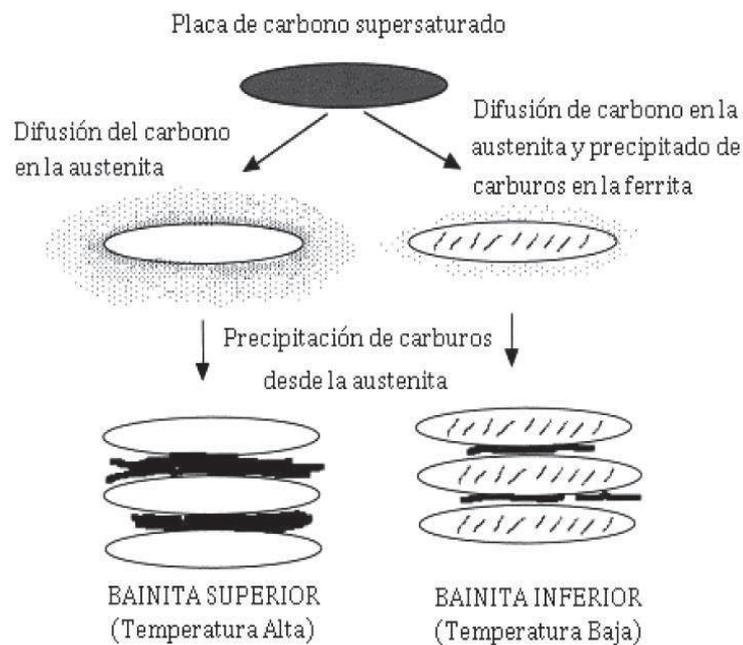
Figura 1.18 Evolución y crecimiento de la bainita superior e inferior <sup>[7]</sup>
