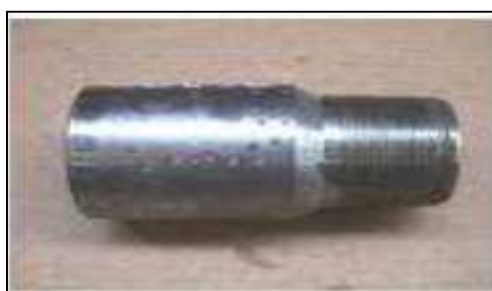
Figura 2.27 Válvula de retención
