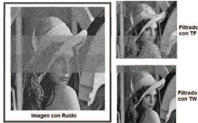
FIGURA 3.5.3.2: Comparación entre la Transformada de Fourier y Wavelet para el filtrado de imágenes
