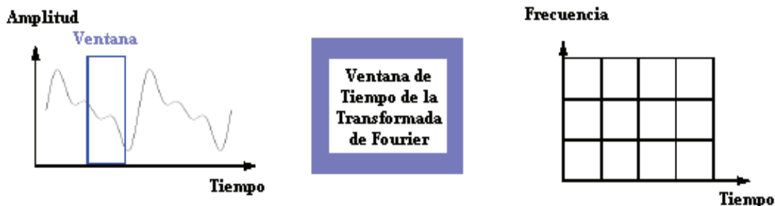
FIGURA 3.1.3: Esquema de la resolución fija en tiempo y frecuencia de la Transformada Corta de Fourier
