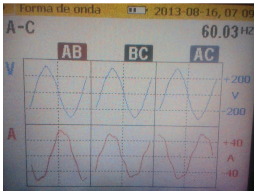
FIGURA 4.5.5.3: Formas de onda de voltaje y corriente en las fases AB, BC y AC
