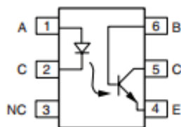
Figura 2-29 Esquema del optoacoplador 4N25.
