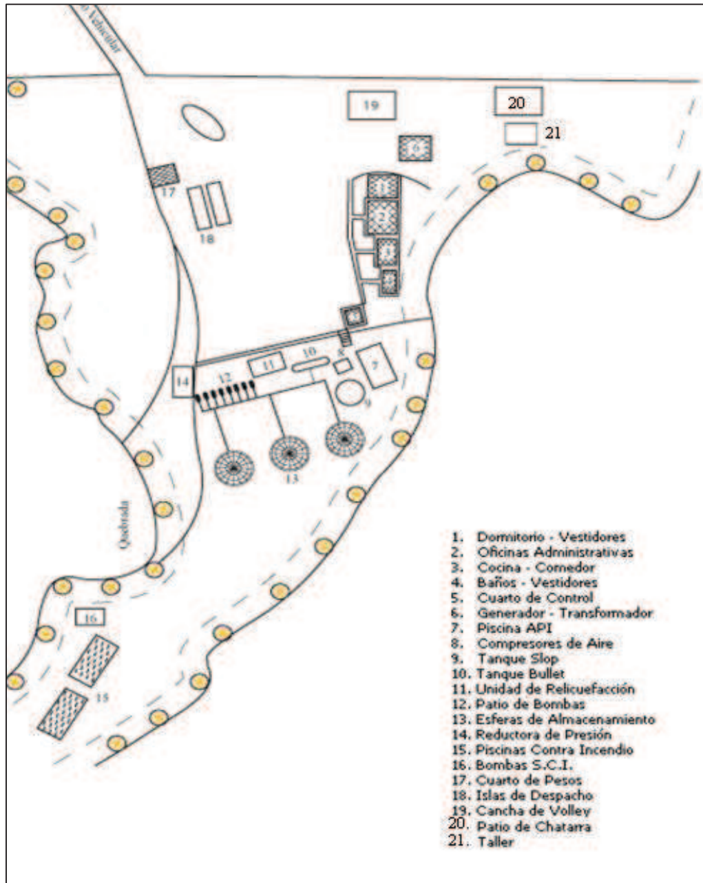
FIGURA 1-3: IMPLANTACIÓN DEL TERMINAL DE GLP OYAMBARO
