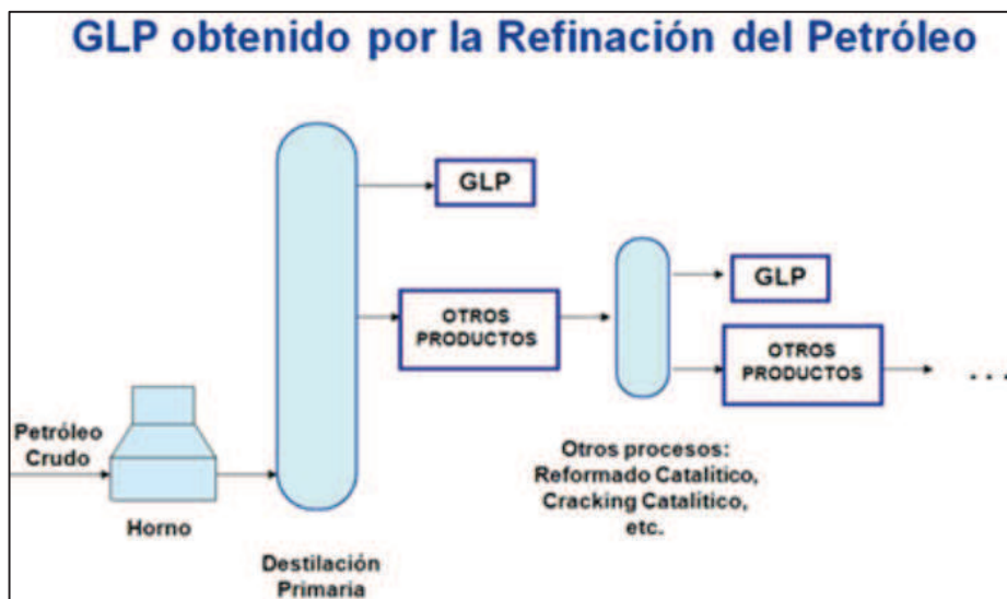
FIGURA 2-2: PROCESO PARA OBTENER GLP A PARTIR DE PETRÓLEO CRUDO
