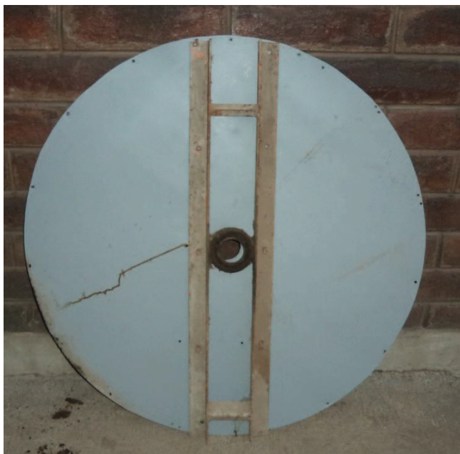
Fotografía. Montaje de soporte de rodamiento.
