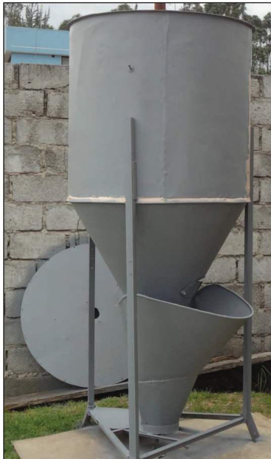
Fotografía 4.2.1 Armado de Estructura y Tolva de Almacenamiento.
