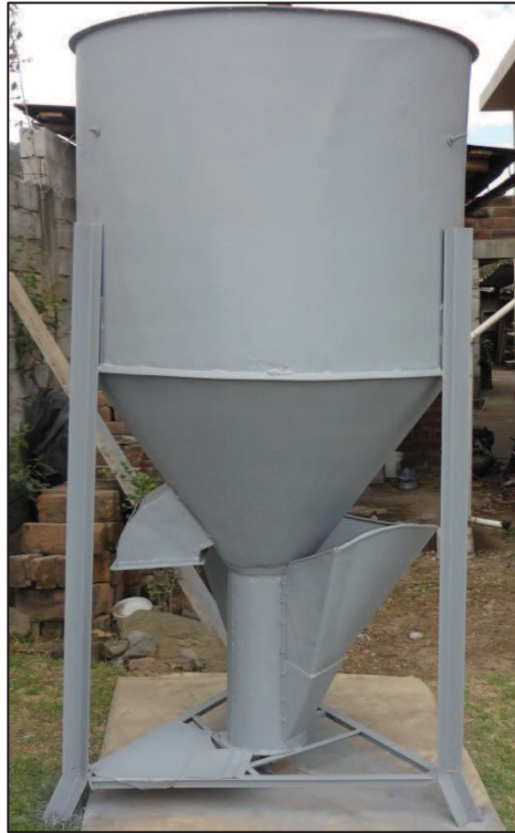
Fotografía 4.3.1 Montaje del conducto de descarga y hélice helicoidal.
