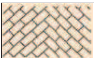
Imagen 2.13: Colocación en espiga
