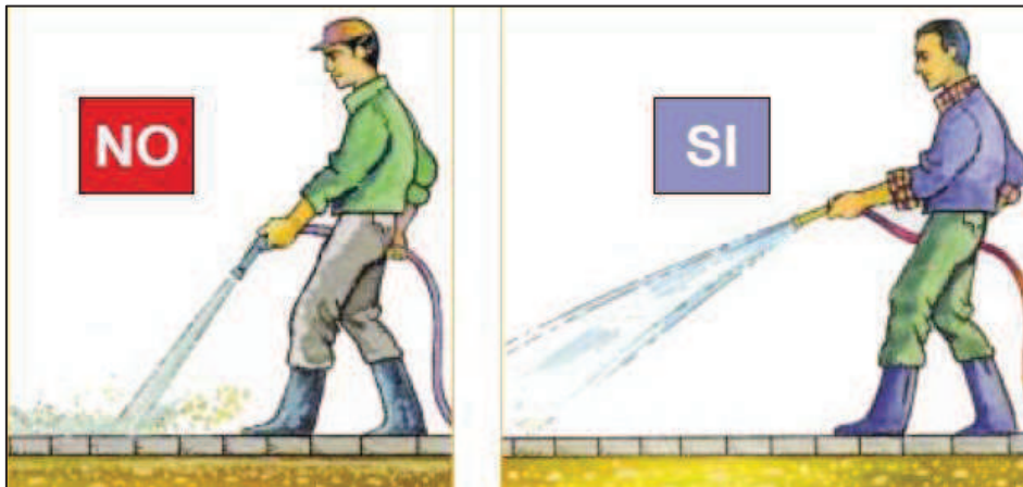
Imagen 2.10: Limpieza del adoquinado con agua
