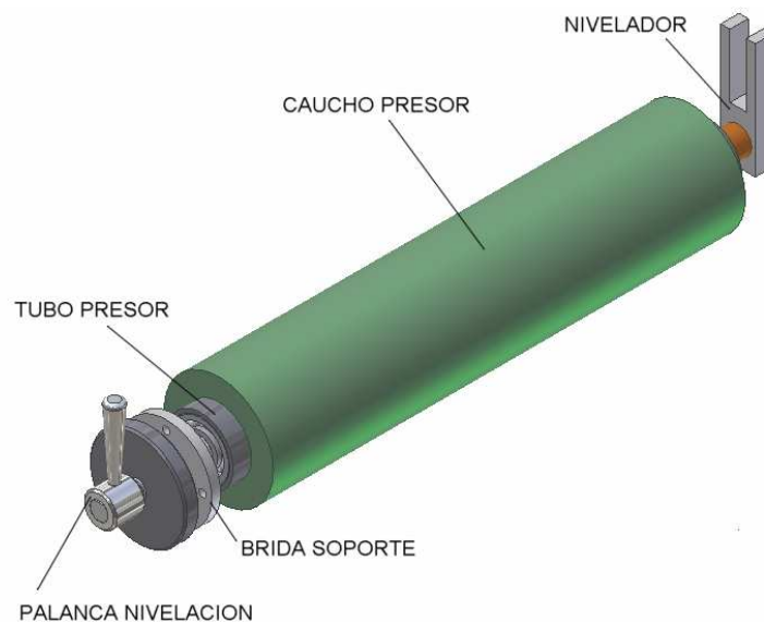
Figura 3-40: Vista isométrica del rodillo presor. 126
