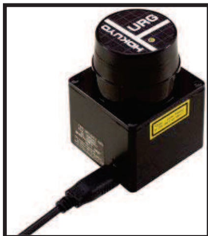
Fig. 1.28 Láser Hokuyo URG-04LX-UG0, tomado de [9].
