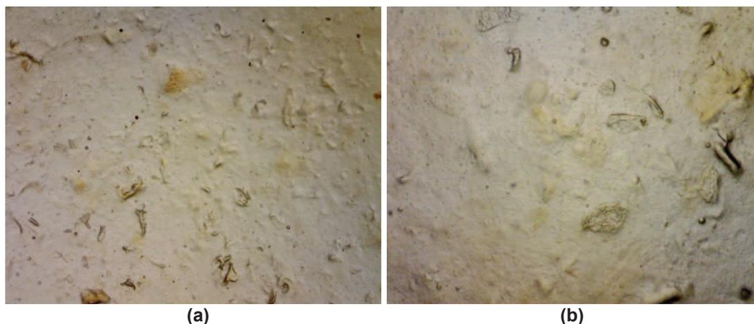
**Figura 3.20.** Micrografías de la superficie de la formulación 10 obtenidas a través de microscopio óptico a un aumento de 180 x (a) y 540 x (b)
