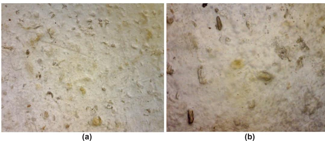
**Figura 3.15.** Micrografías de la superficie de la formulación 5 obtenidas a través de microscopio óptico a un aumento de 180 x (a) y 540 x (b)
