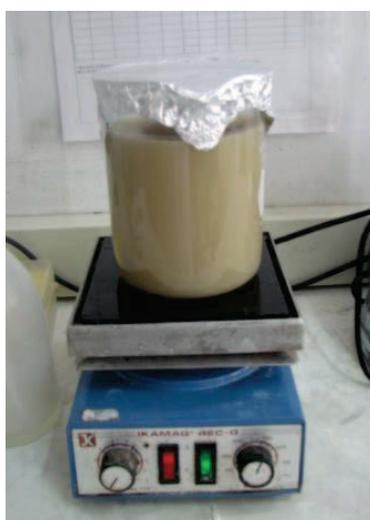
**Figura AIII.4.** Adición de almidón modificado y homogenización
