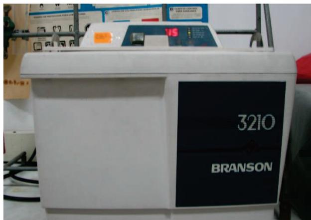
**Figura AIII.3.** Baño de ultrasonido 15 min
