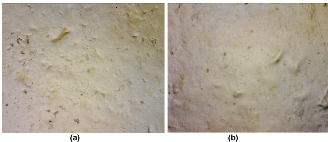
**Figura 3.12.** Micrografías de la superficie de la formulación 2 obtenidas a través de microscopio óptico a un aumento de 180 x (a) y 540 x (b)
