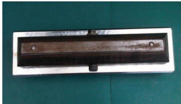
**Figura AVII.2.** Probeta para ensayos de tracción
