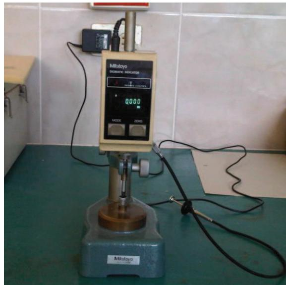
**Figura AVII.4.** Micrómetro digital Mitutoyo
