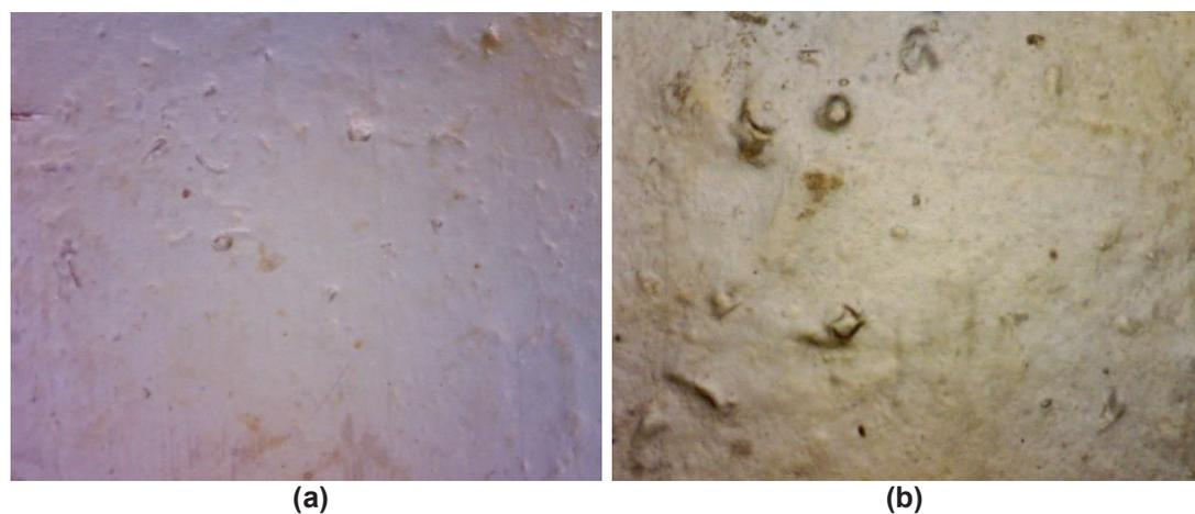
**Figura 3.19.** Micrografías de la superficie de la formulación 9 obtenidas a través de microscopio óptico a un aumento de 180 x (a) y 540 x (b)
