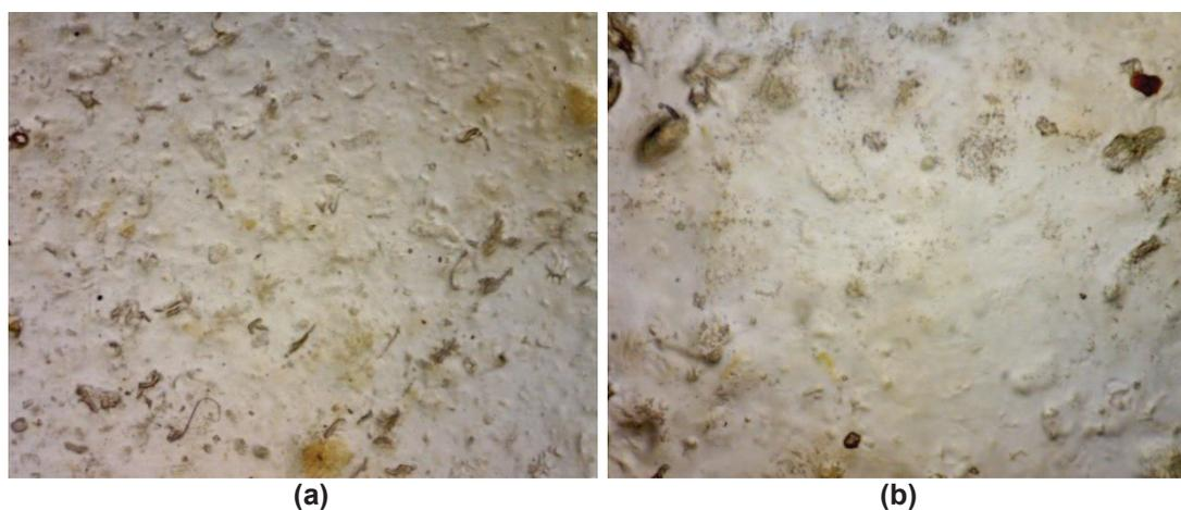
**Figura 3.16.** Micrografías de la superficie de la formulación 6 obtenidas a través de microscopio óptico a un aumento de 180 x (a) y 540 x (b)
