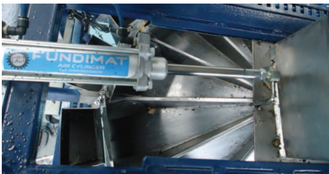
Figura 2.3 Acoplamiento del vástago a la compuerta dosificadora
