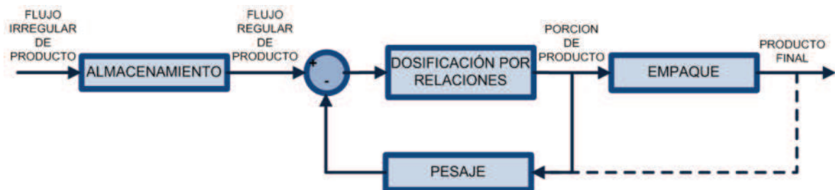
Figura 1.14 Dosificación por relaciones, con realimentación de peso
