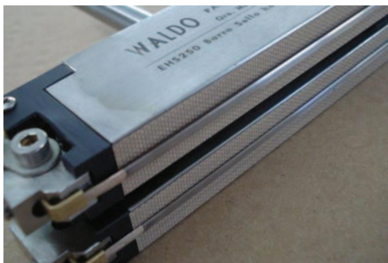
Figura 2.36 Niquelinas planas para sellado, tomado de [33]
