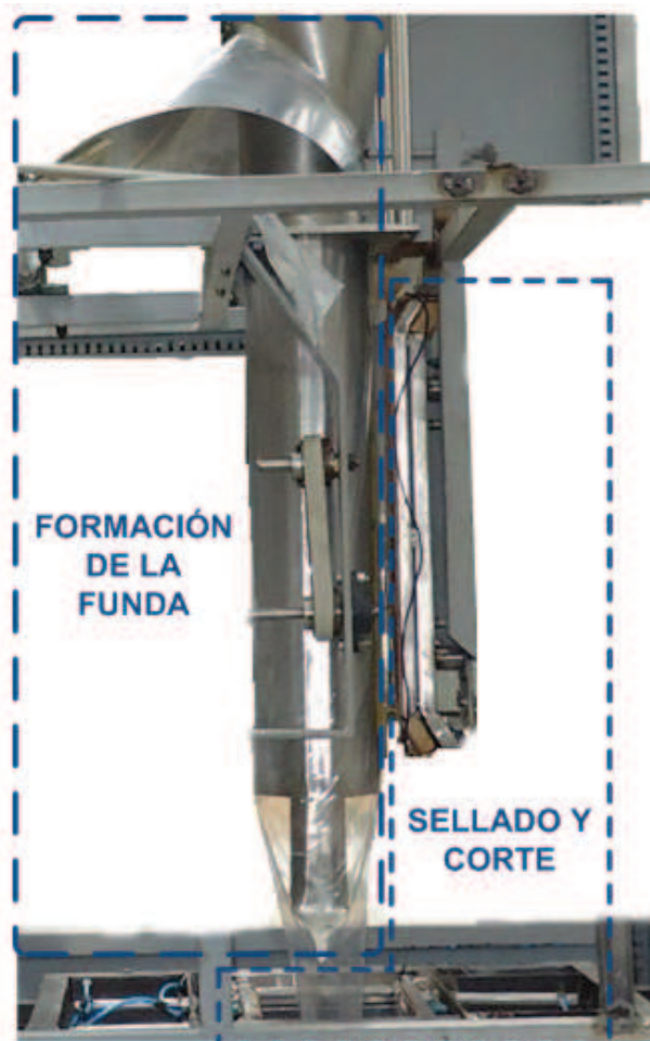
Figura 1.42 Piezas involucradas en la formación, sellado y corte de la funda.
