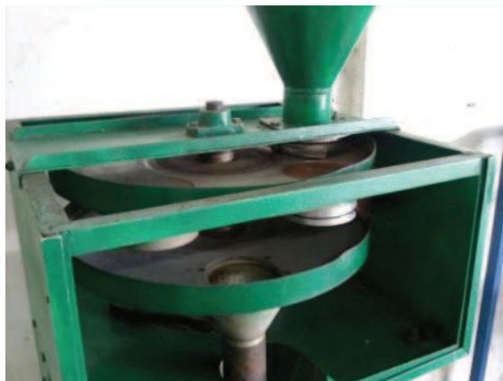
Figura 1.13 Dosificador por copas con desfogue único, tomado de [13]
