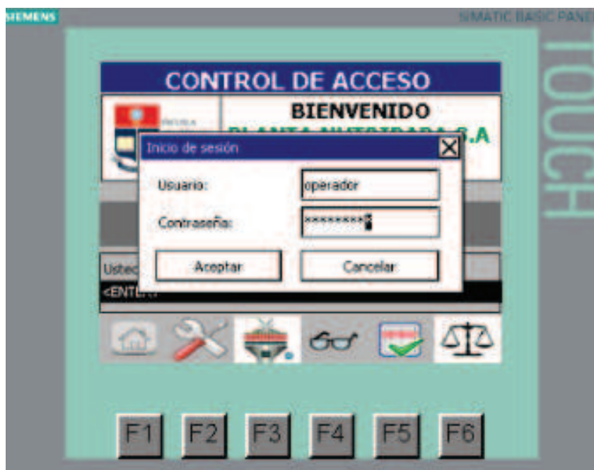
Figura 3.17 Pantalla de control de acceso
