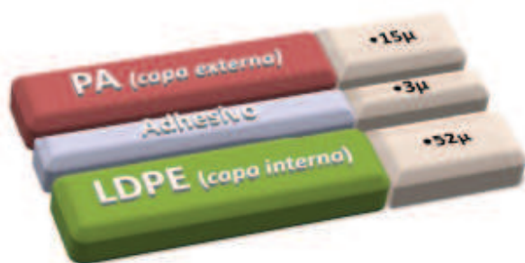
Figura 1.2 Estructura interna de Vacuflex70, tomado de [6]
