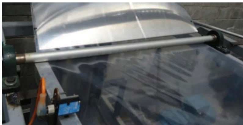
Figura 2.23 Ubicación del sensor de contraste
