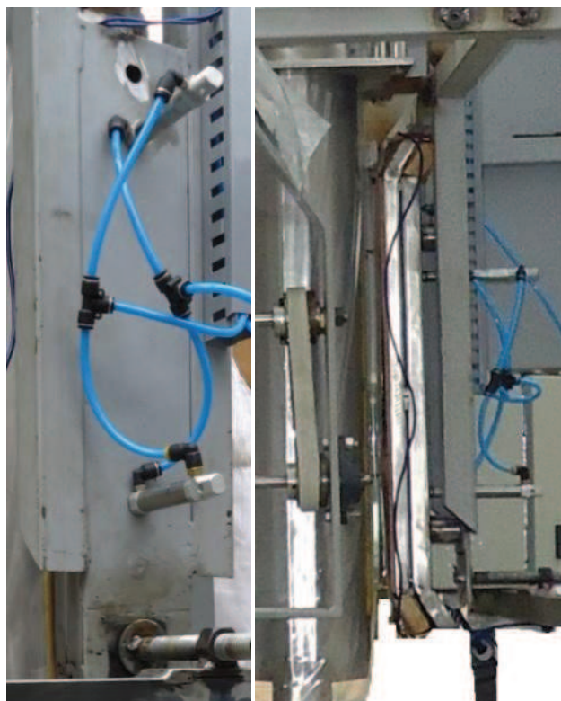
Figura 2.30 Ubicación de los pistones DSNU 20x25 en la mordaza
