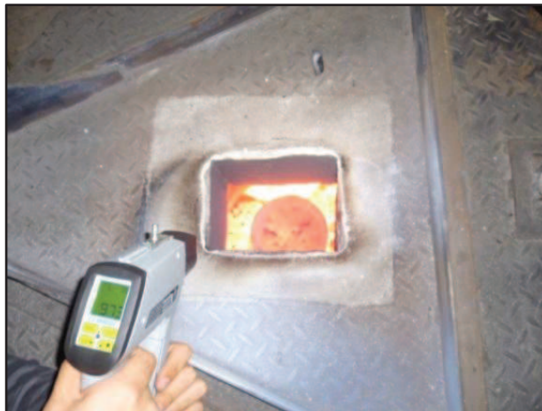
Figura 3. 25. Medición de la temperatura durante el proceso de reducción.
