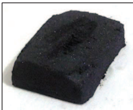
Figura 3. 12. Briqueta de arena ferruginosa.
