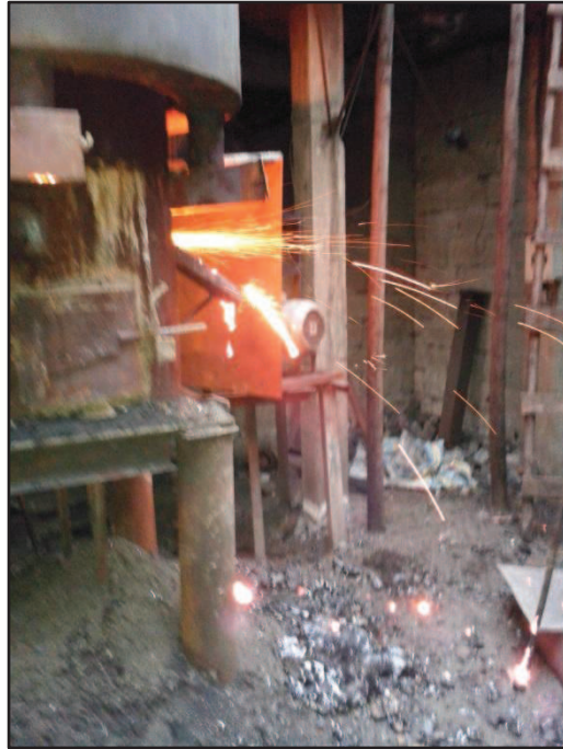
Figura 3. 33. Salida de la arena reducida por la piquera de escoriado.
