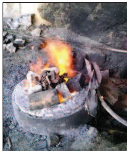
Figura 3. 29. Horno de foso precalentado.
