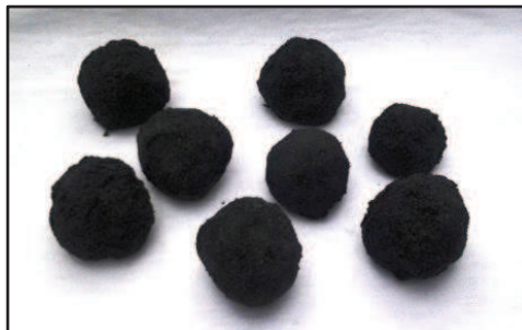
Figura 3. 10. Pellets de arena con melaza.
