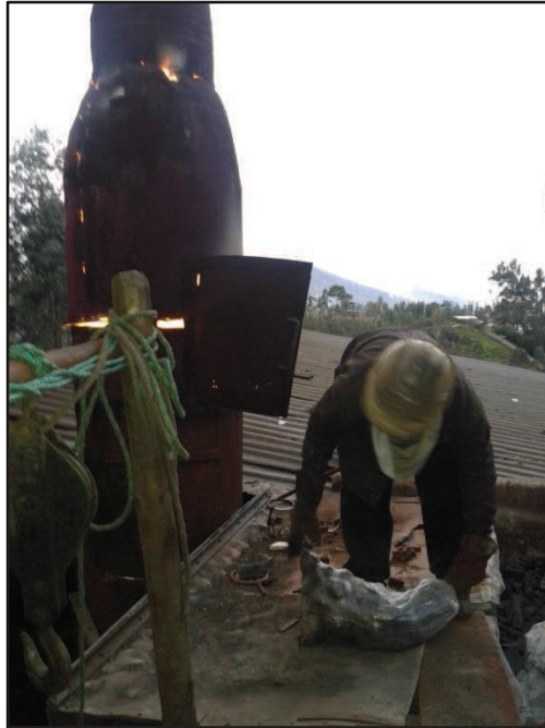
Figura 3. 31. Carga de pellets de arena.
