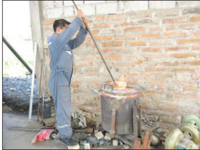
Figura 3. 26. Horno de crisol a gas en operación.
