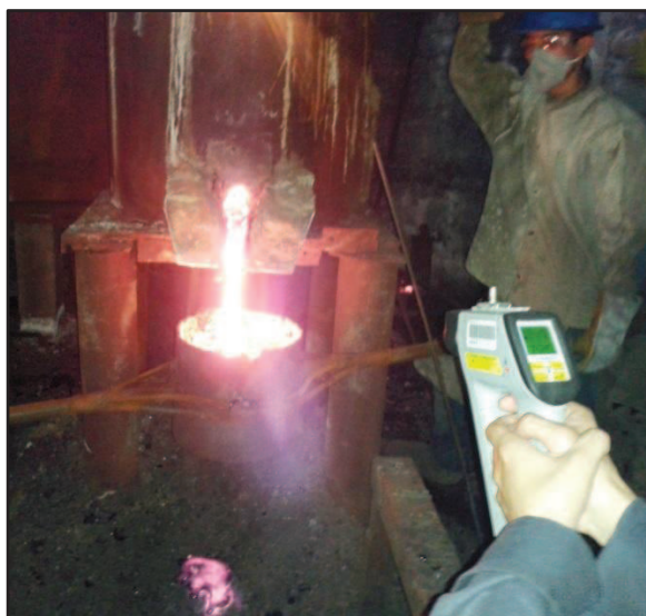
Figura 3. 34. Salida de las arenas reducidas por la piquera de sangrado.
