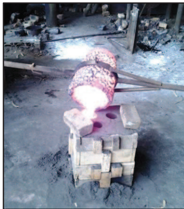
Figura 4. 7. Vertido de colada en el molde.
