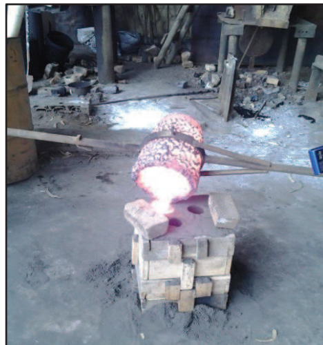
Figura 3. 30. Vaciado de la colada en el molde.
