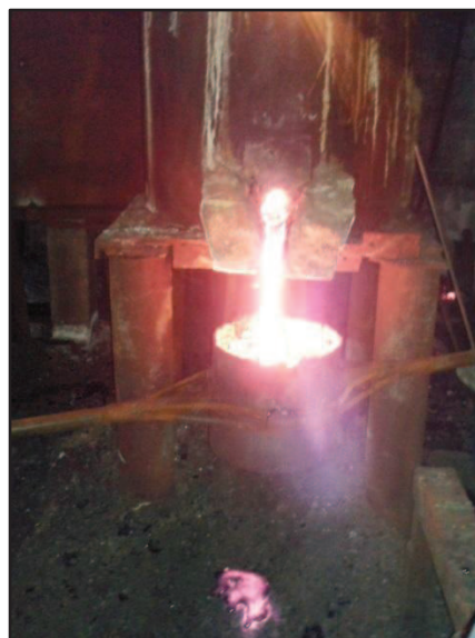
Figura 4. 10. Descarga de arenas reducidas.
