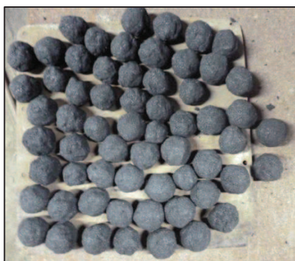
Figura 3. 11. Pellets de arena con silicato de sodio.
