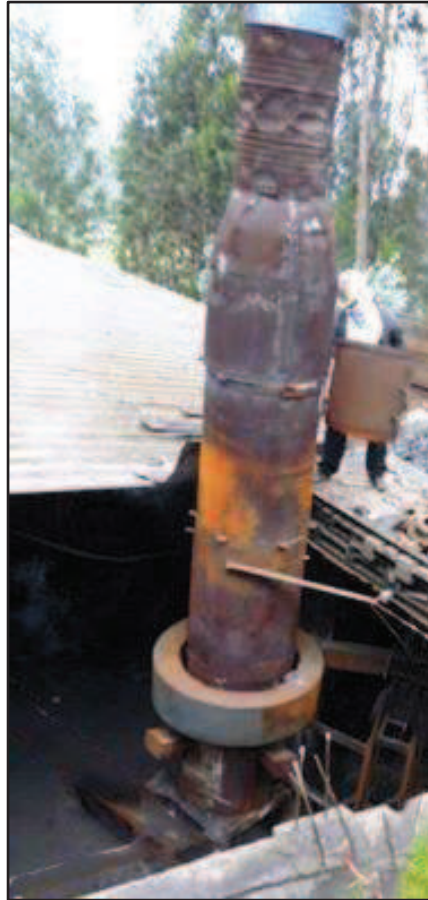
Figura 3. 21. Horno de cubilote de la empresa TECNO FUNDICIÓN.
