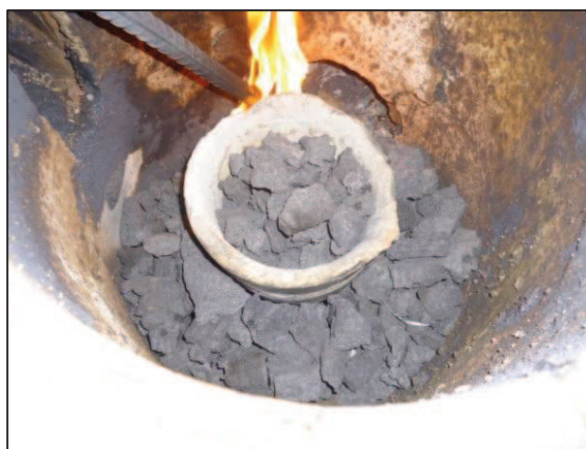
Figura 3. 24. Crisol cargado en el interior del horno fijo.
