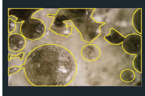
Figura AII.3. Áreas vítreas delimitadas de la fotografía de la muestra EF-1 con temperatura de fusión de 700 °C
