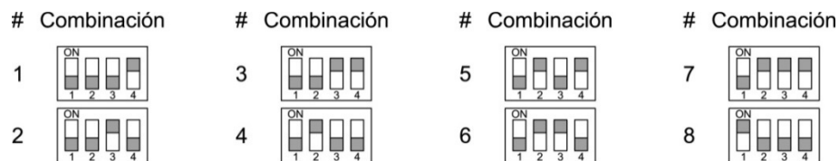
Figura 2.46 Combinaciones binarias de los microinterruptores del DIP switch de direccionamiento de la interfaz CCI
