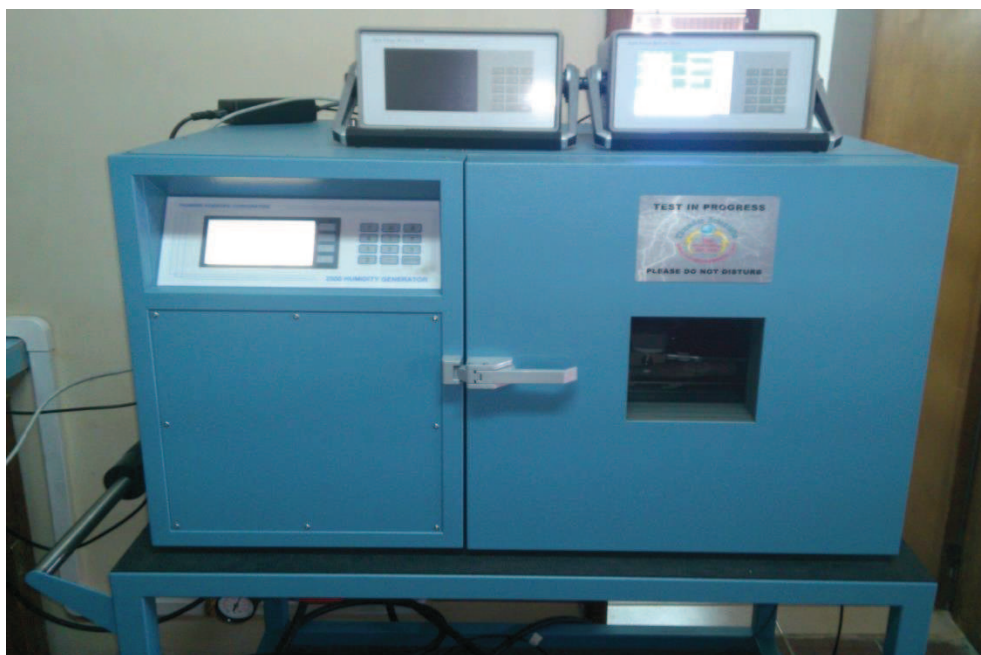
Figura 4.6 Calibración del Sensor de Humedad HMP45A, en el Laboratorio de Metrología del INAMHI, por Medio de la Utilización de una Cámara de Humedad
