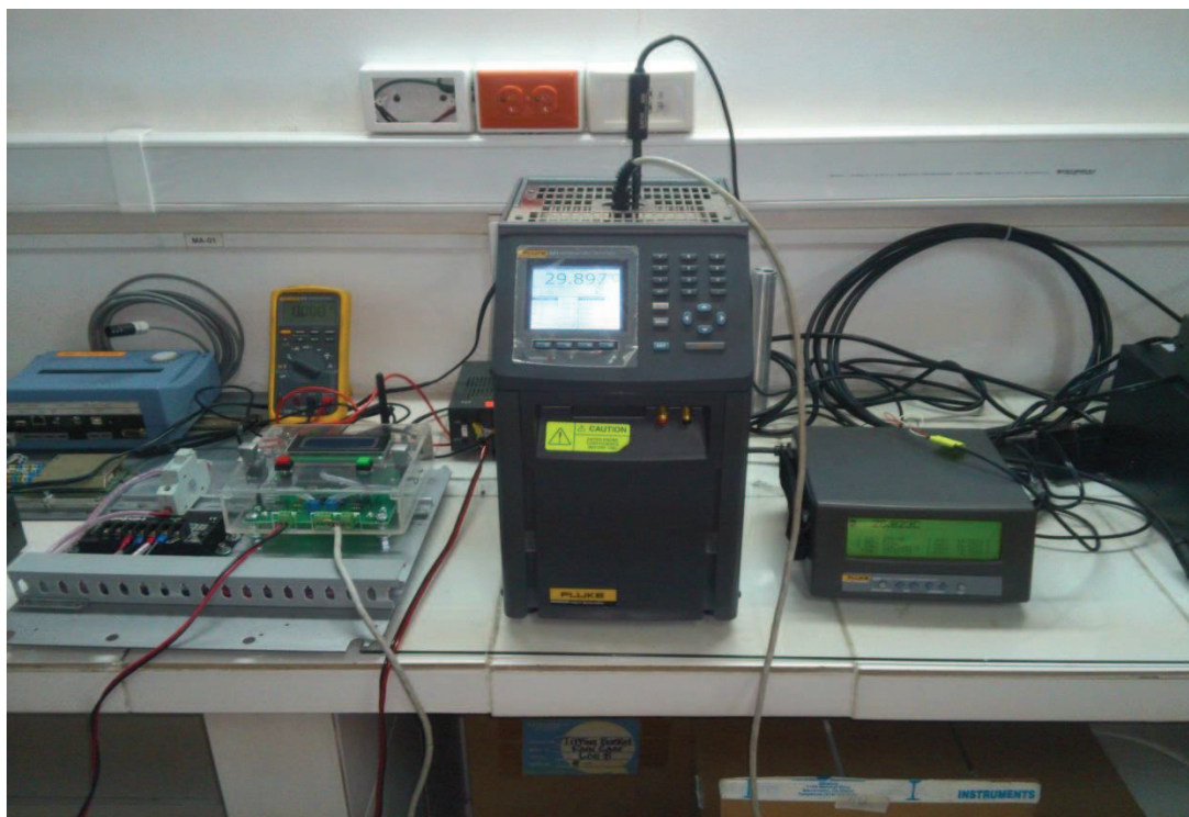
Figura 4.3 Calibración del Sensor de Temperatura HMP45A, en el Laboratorio de Metrología del INAMHI, por Medio de la Utilización de una Cámara de Pozo Seco
