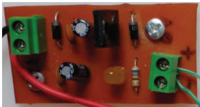
Figura 3.11 Regulador de voltaje de 6V.
