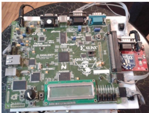
Figura 3.7 Disposición física de la tarjeta Spartan 3E placa superior.
