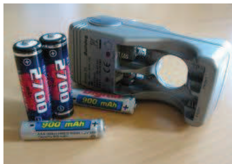
Figura 2.17 Baterías Ni-MH tipo pila recargable, tomado de [27]
