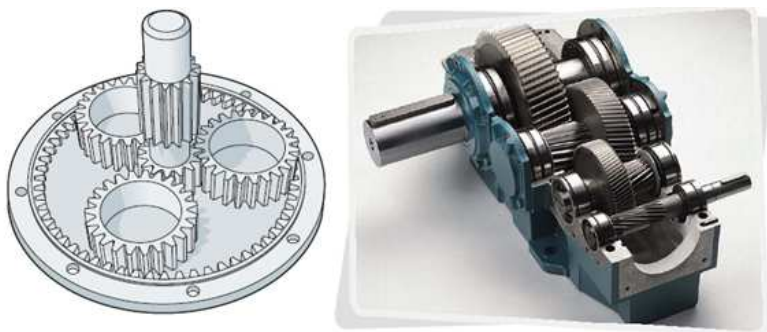
Figura 2.9 Tipos de engranajes utilizados en cajas multiplicadoras de velocidad [11]
