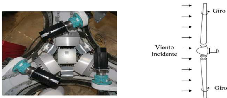
Figura 2.16 Sistema electromecánico para el control del ángulo de las hélices [13]
