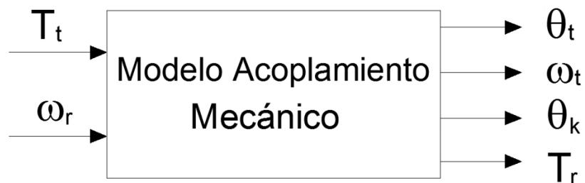
Figura 2.15 Esquema del modelo de acoplamiento mecánico
