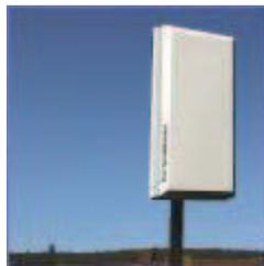
LTE MIMO Flachpanel Antenne, wetterfestes Gehäuse, Frequenz 791-862 MHz
