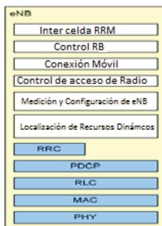
Figura 1.15: Separación funcional entre el eNB, MME, SGW y PGW <sup>[12]</sup>
