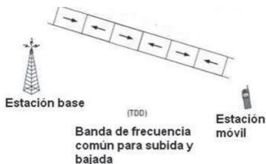
Figura 2.16: Acceso bidireccional TDD [35]
