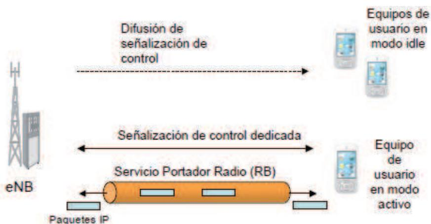
Figura 1.16: Mecanismos de transferencia de información en la interfaz radio <sup>[17]</sup>
