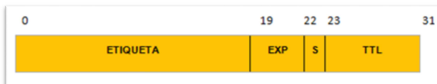
Figura 1.4: Estructura de la cabecera de un paquete MPLS (etiqueta) [7]
