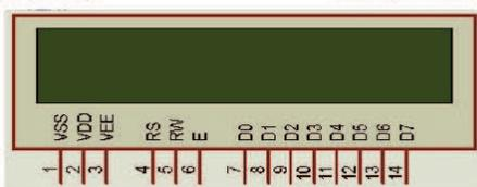
Figura A.7.6 Hoja de datos LCD Lm020L
