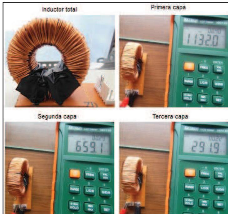
Con estos valores mediante la ecuación 2.27 se puede determinar el valor de la permeabilidad relativa de la ferrita utilizada.
