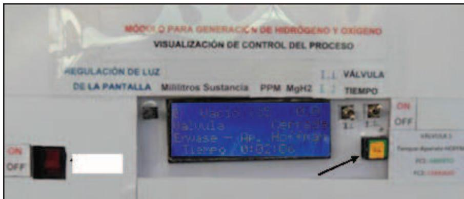
5. Cuando la válvula está abierta (Figura A.2.5), presionar nuevamente para cerrarla ó dejar que se cierre automáticamente.
