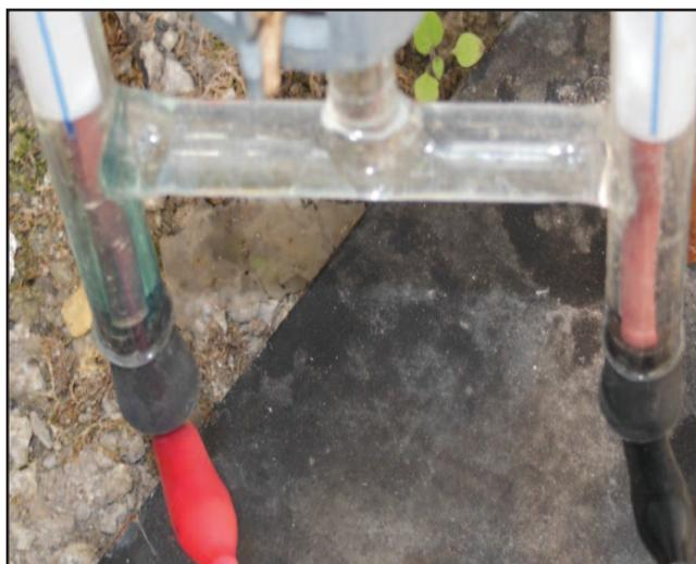
En la Figura 4.18 se utiliza una concentración del 10% de hidróxido de sodio NaOH, para la generación del gas oxígeno.
