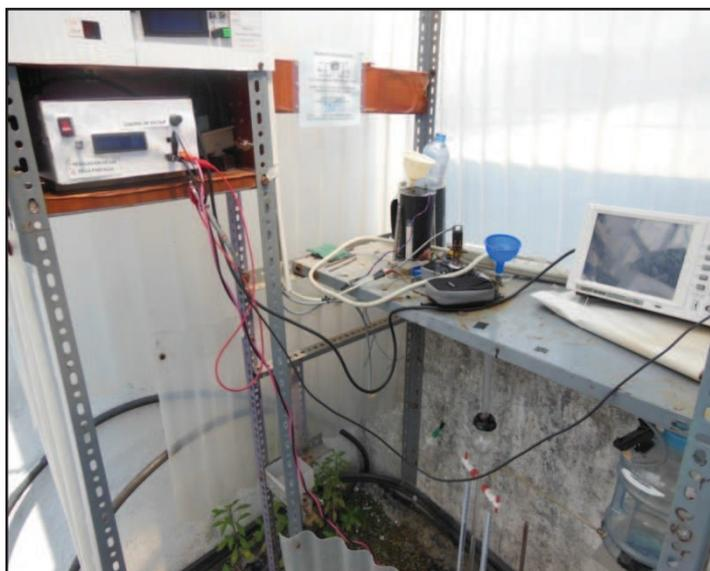
Las pruebas hechas con el osciloscopio en el proceso de generación de gases están a una concentración de 30% del ácido sulfúrico (20% concentrado). El valor de la carga R-E (resistencia + voltaje) depende de la concentración de electrolito. A una
