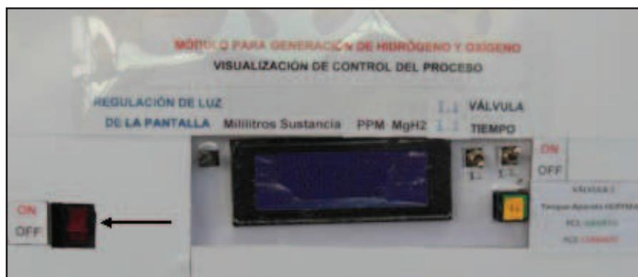
4. Presionar el pulsador verde para que ingrese la cantidad de líquido al aparato Hoffman donde se desarrollará la electrólisis del agua. La válvula se cierra automáticamente antes de los 50 mililitros. Es de corta duración, no mayor a 3 segundos.
