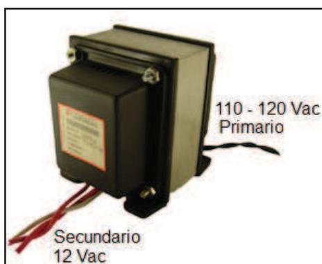
En la Figura 1.4, se visualiza la parte primaria del transformador y su función es recibir energía eléctrica de la red y el otro extremo del transformador es el que suministra energía al resto de circuitería que se conecte, se denomina secundario.
