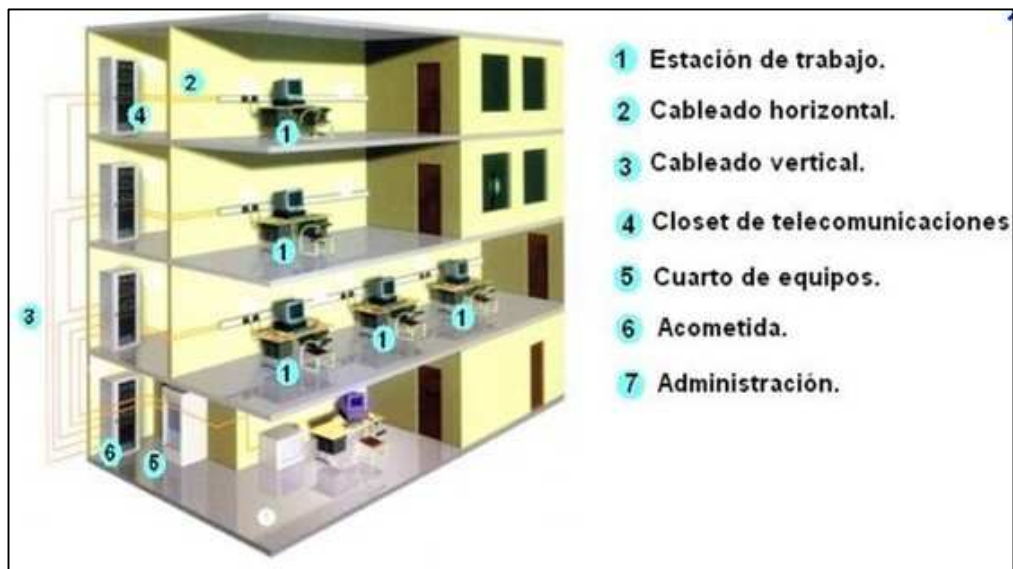
Figura 1.7 Subsistemas de cableado estructurado.
