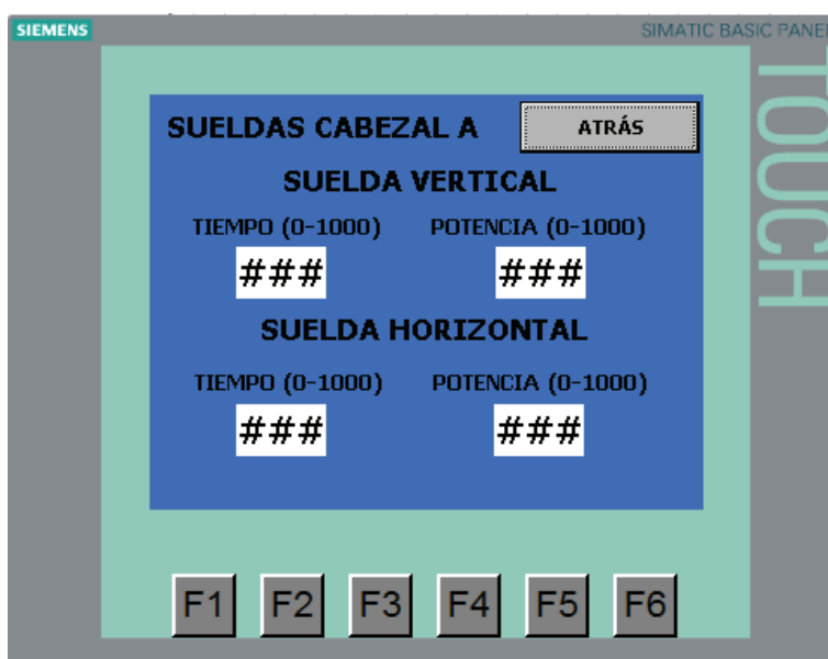
Figura 3.15 Imagen para calibración de las sueldas.
