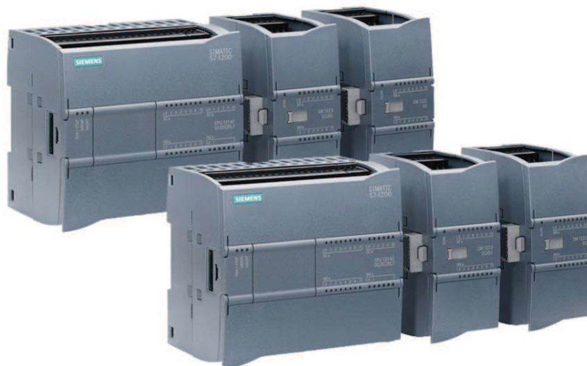
Figura 2.5 Conexión de los módulos de expansión.
