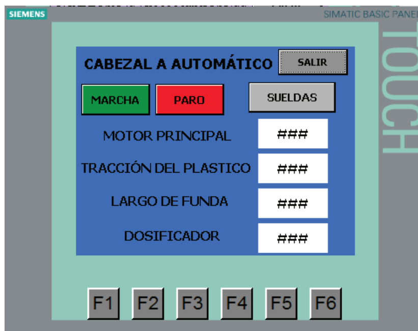
Figura 3.9 Imagen complementaria del cabezal A en modo automático.
