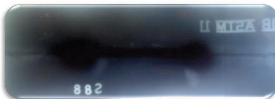
**FIGURA 86:** *Radiografía cordón de soldadura Acero A 588 Gr. A Ensayo Y-GROOVE*
