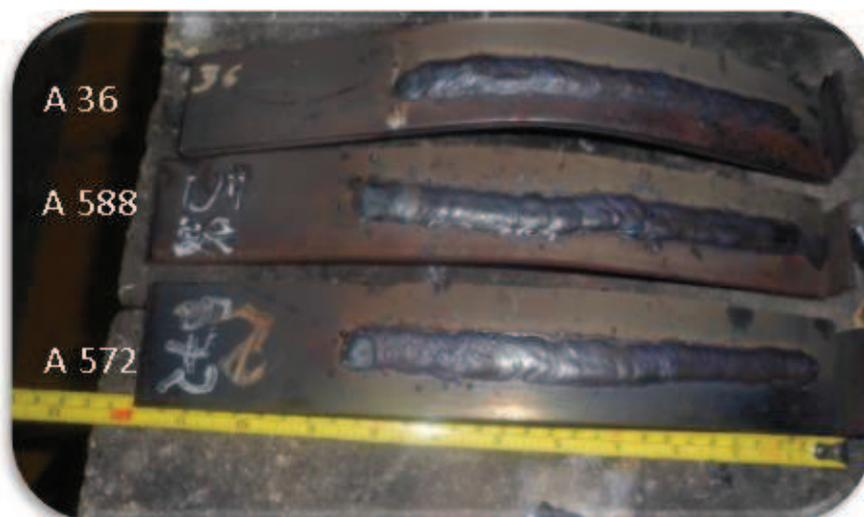
**FIGURA 55:** Cordones de soldadura en los tres tipos de acero (Acero A.36, A 572 Grado 50 y A 588 Grado A) posteriores al ensayo VARESTRAINT
