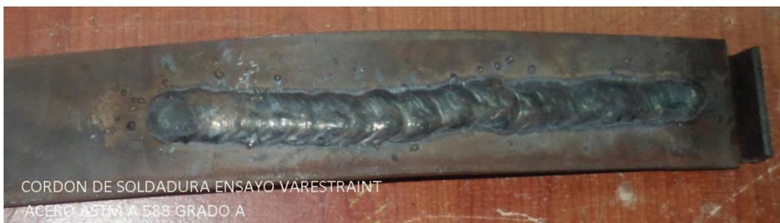
**FIGURA 58:** Análisis visual cordón de soldadura ensayo VARESTRAINT Acero A 588 Grado A
