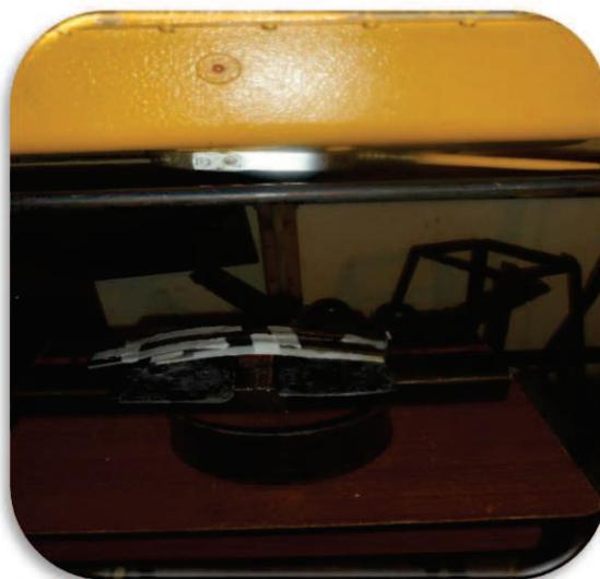
**FIGURA 60;** *Probeta Acero A 572 Gr 50 en mesa de Radiografía*
