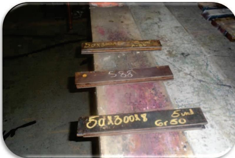
**FIGURA 47:** Preparación de probetas para ensayo VARESTRAINT
