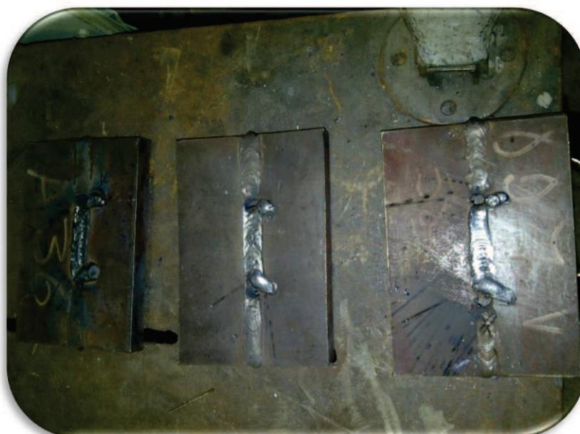
**FIGURA 79:** Placas soldadas luego de proceso FCAW.
