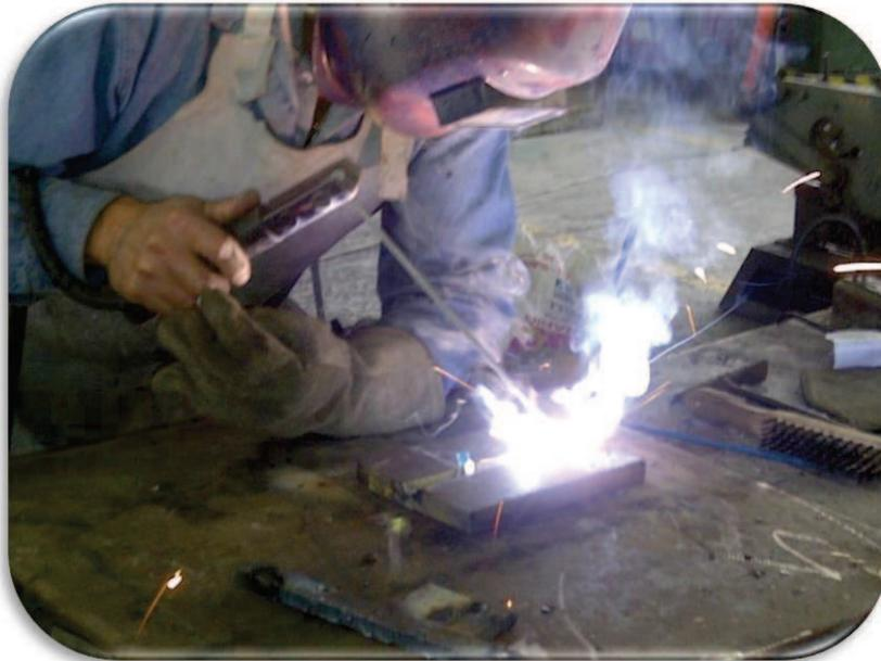
**FIGURA 75:** Soldadura de Restricción en placas proceso SMAW
