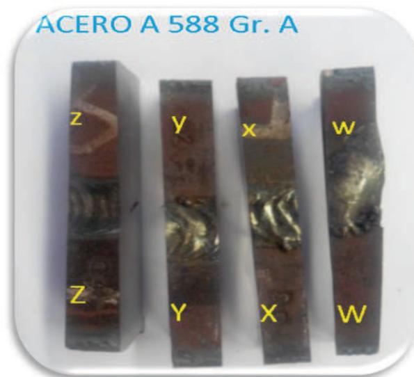
**FIGURA 92:** *Probetas acero A 588 Gr A preparadas para macro y micrografías*
