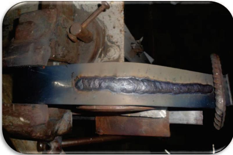
**FIGURA 53:** *Cordón de soldadura luego de ensayo VARESTRAINT, en acero A-572 Grado 50.*
