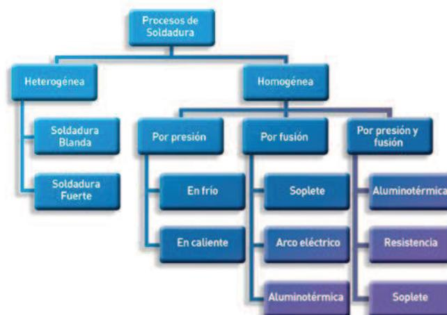
Figura 4. Esquema de clasificación de los diferentes tipos de soldadura.
