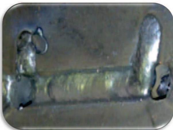
FIGURA 82; Cordón en acero ASTM A 572 Gr. 50
