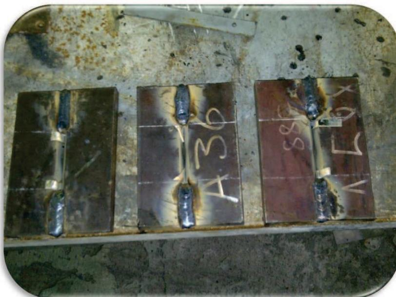
**FIGURA 76:** Placas luego de la suelda de restricción.
