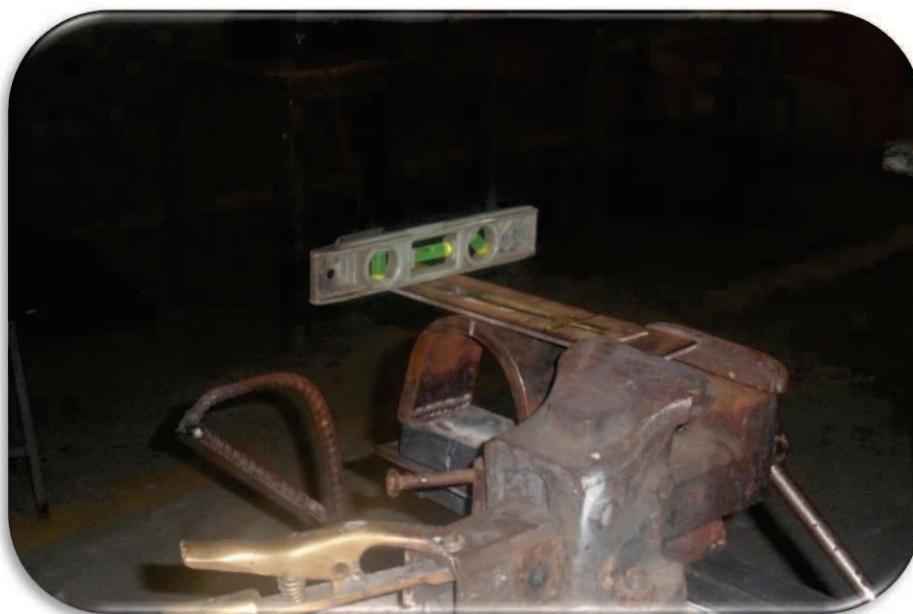
**FIGURA 51:** Nivelación de probeta para ajustar dado con curvatura.
