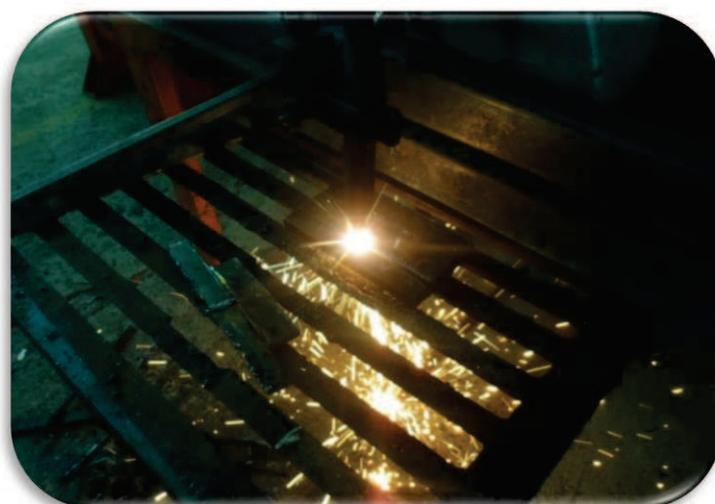
**FIGURA 90;** Corte de placa para probetas ACERO A 588 Grado A.
