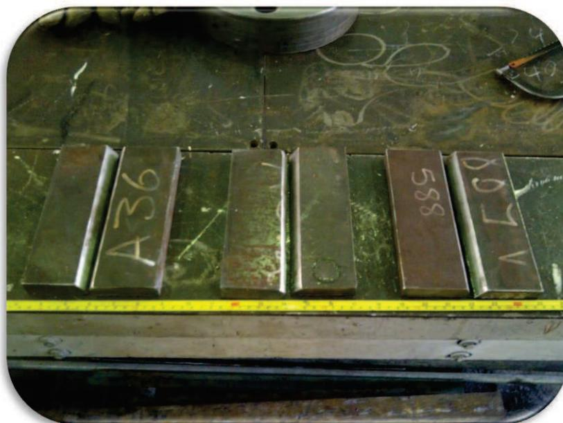
**FIGURA 73:** Limado de placa para ensayo Y-GROOVE
