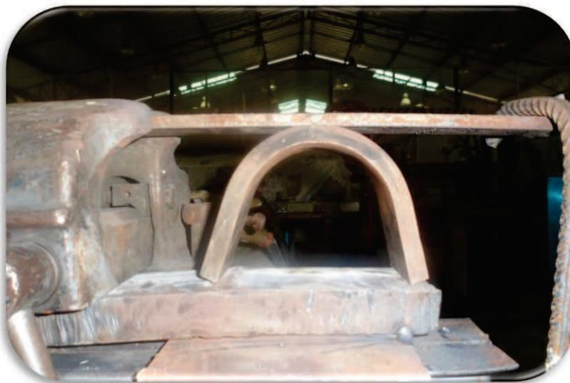
**FIGURA 50:** Arreglo preparado con curvatura para ensayo VARESTRAINT.
