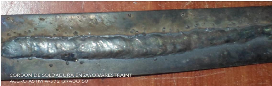
**FIGURA 57:** Análisis visual cordón de soldadura ensayo VARESTRAINT Acero A 572 Grado 50
