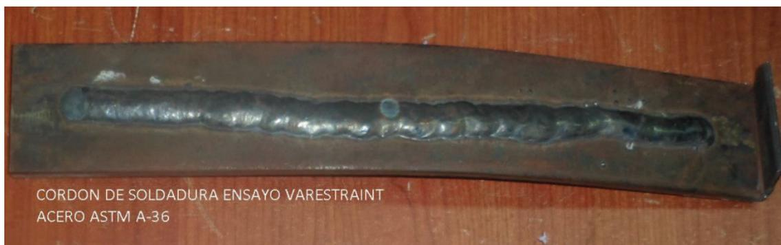
**FIGURA 56:** *Análisis visual cordón de soldadura ensayo VARESTRAINT Acero A 36*
