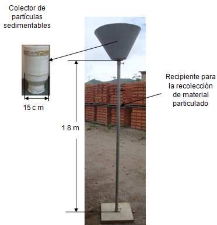
Figura AI. 1. Esquema para la recolección de partículas sedimentables
