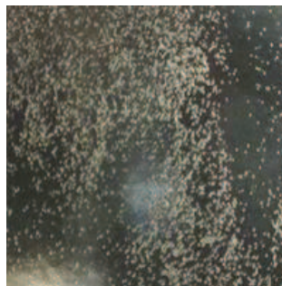
Figura 1.15 Placa con defecto de hervido (CISP, 2010b, p. 3)
