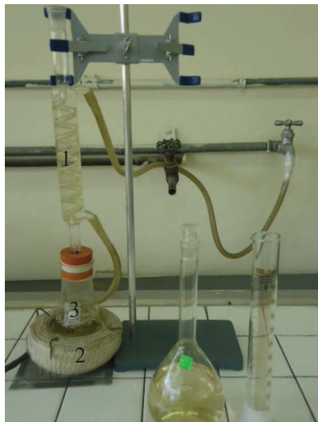
Figura 2.7 Equipo para la determinación de la resistencia al ataque químico con ácido cítrico en ebullición el 6% en peso. 1.- Refrigerante. 2.- Camisa de calentamiento. 3.- Erlenmeyer
