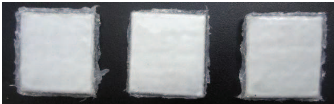
Figura 3.3 Placas a las que se realizó la prueba de resistencia al ácido cítrico
