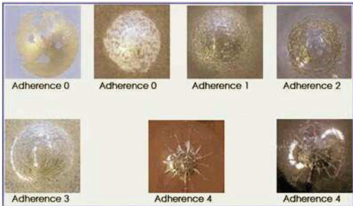
Figura A 2 Formas de comparación para determinar la adherencia de esmaltes porcelánicos impactados por objetos esféricos (Mora, 2008, p. 105)
