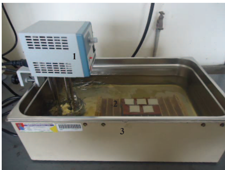
Figura 2.6 Esquema del equipo para determinación de la resistencia al choque térmico. Elementos: 1.- Termostato Thomas Scientific ( T_{\max} 100 [°C] apreciación 2 [°C]) 2.- Base cerámica. 3.- Baño termostático
