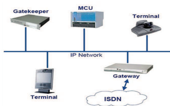
Figura 1-10 Componentes de la Arquitectura H.323 [G13]
