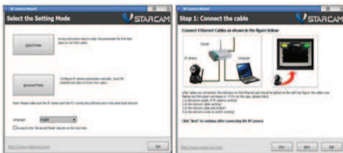
Figura 4-27 Proceso de instalación de la cámara IP Vstarcam F6836w
