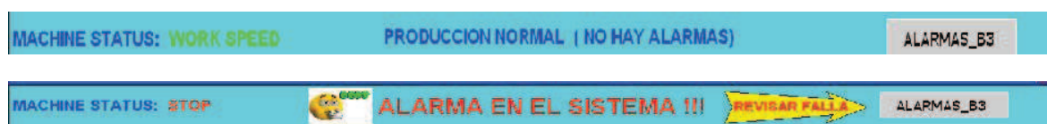
Figura 3. 9 Ventana de Alarmas
